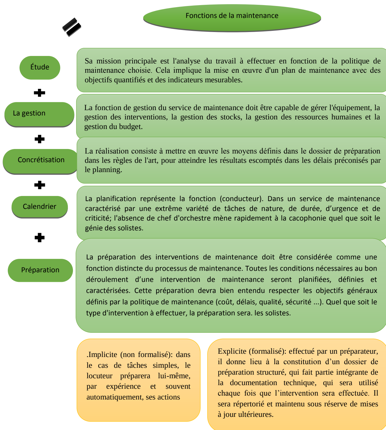
Figure II-Fonctions de la maintenance. (Norme FD X 60-000)
