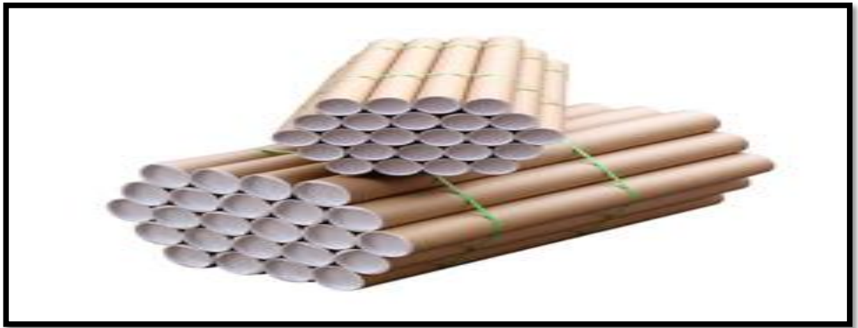
Figure I- Transforme le papier liner en tubes en carton appelés mandrins
