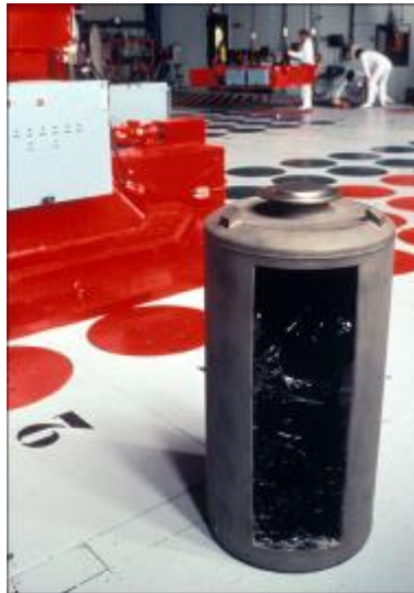
Figure A.20 : prototype d'un colis de vitrification d'un déchet HAVL [8].
