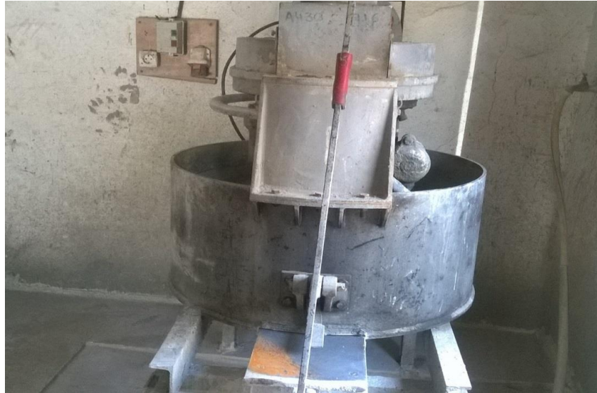
Figure 28 : Malaxeur de béton
