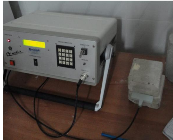
Figure V.11 : Essais de la conductivité thermique
