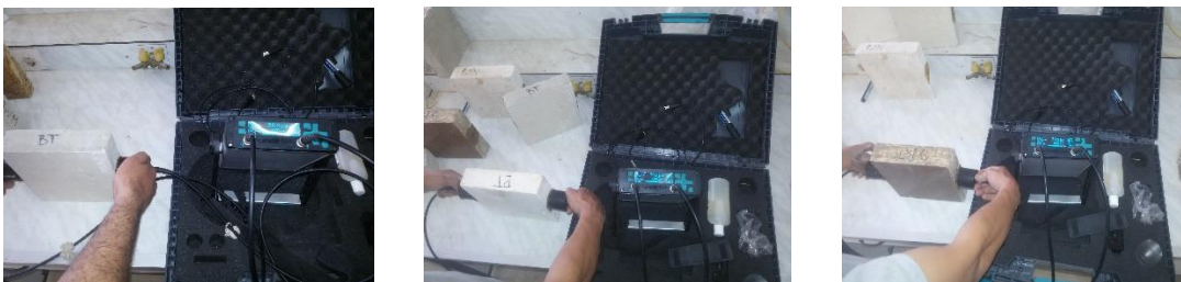
FigureV.7 : Essai non destructif ultrason
