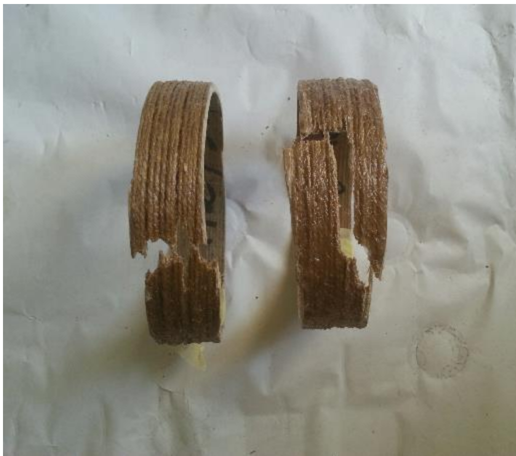
Fig IV.53. Rupture des éprouvettes par traction circonférentielle
