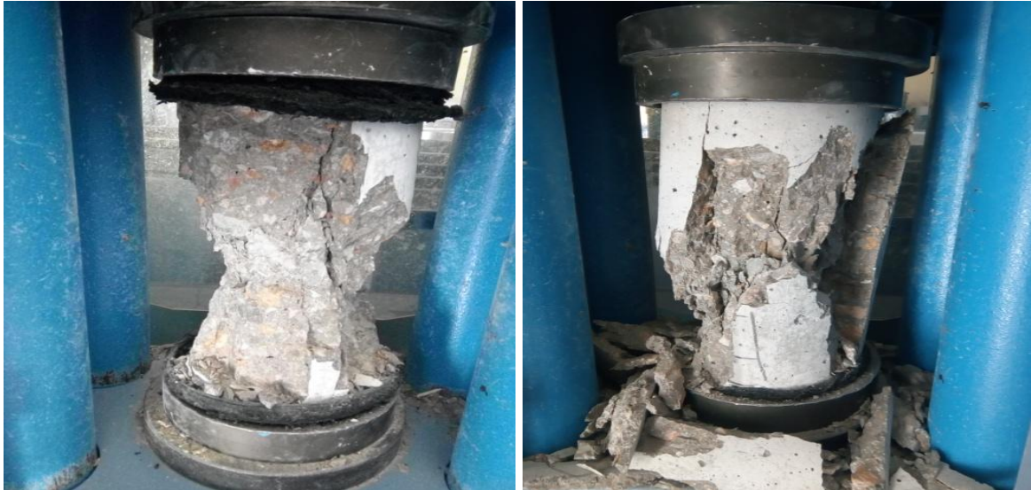
Figure V. 18. Mode de fissuration des éprouvettes.
