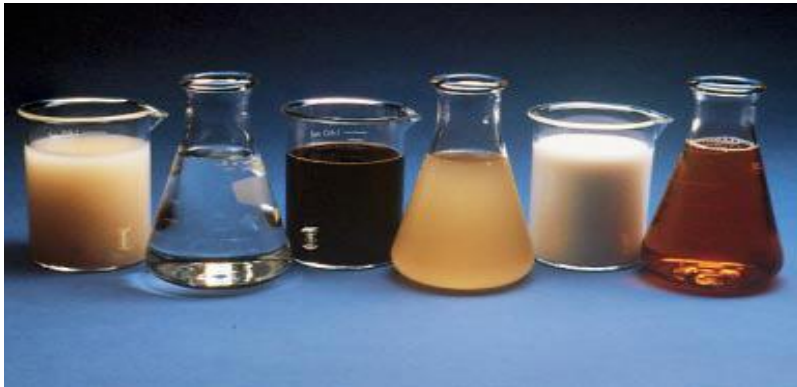
Figure. I. 1. Adjuvants liquide de gauche à droite : agent anti-lessivage , réducteur de retrait , réducteur d'eau ,agent moussant , inhibiteur de corrosion et agent entraîneur d'air
