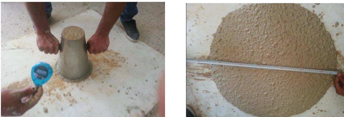
**Figure. IV.2 :** Essai d'étalement (cône d'Abrams).
