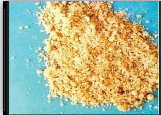
Figure I.9 : Laitier de hauts fourneaux.
