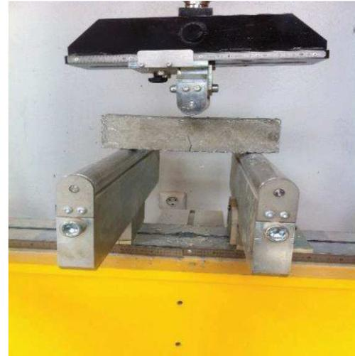
**Figure. IV.15:** appareil de traction par flexion. **Figure.IV.16 :** Essai de traction par flexion.
