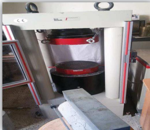
Figure I.15: Machine d'essai de Traction par fendage.
