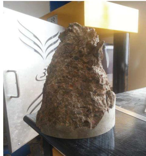
**Figure. IV.13** : Essai de compression.    **Figure. IV.14** : Epreuve après la compression.
