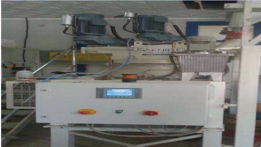
**Figure. IV.1:** Malaxeur utilisé pour la fabrication du béton.
