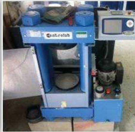
Figure I.14 : Machine d'essai de compression.
