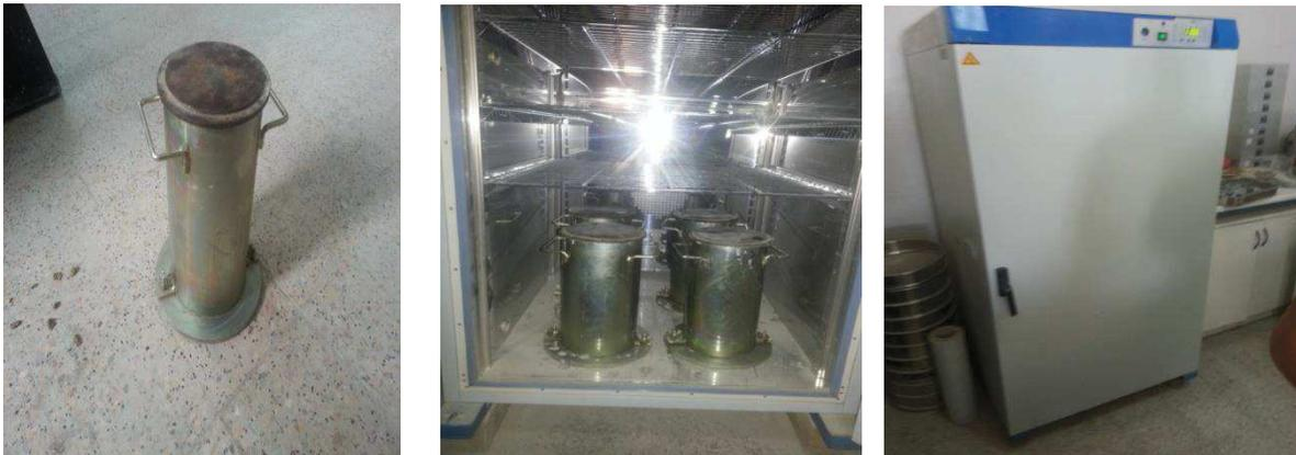
Figure.IV.9 : étuve pour le traitement thermique.
