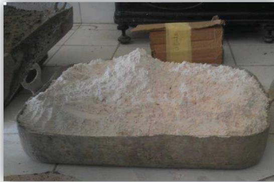
**Figure I.5 :** Poudre de filler calcaire.
