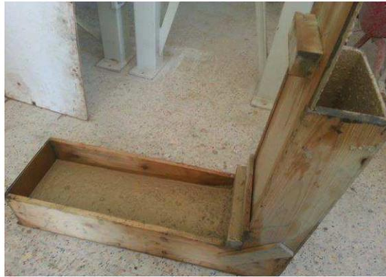
Figure. IV.4 : Essai de la boîte en L.
