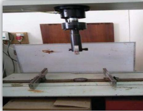
**Figure I.16:** Machine d'essai de Traction par flexion.
