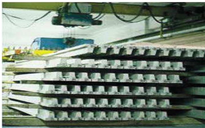
**Figure II.24:** poutrelles standard précontraintes par pré-tension
