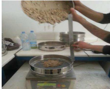
**Figure. IV.6 :** Essai de stabilité au tamis.
