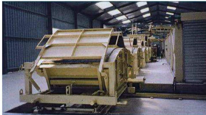
**Figure III.1:** tunnels d'étuvage pour moules de voussoirs.
