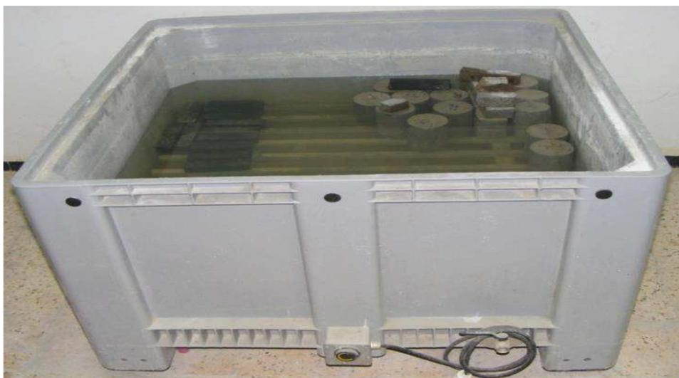
**Figure.IV.12** : Bac de conservation des éprouvettes.
