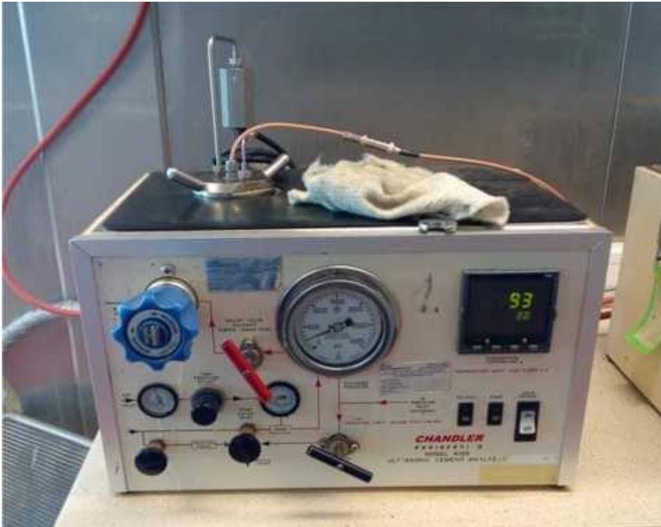
Figure (22) : Ultrasonic Cement Analyser UCA.
