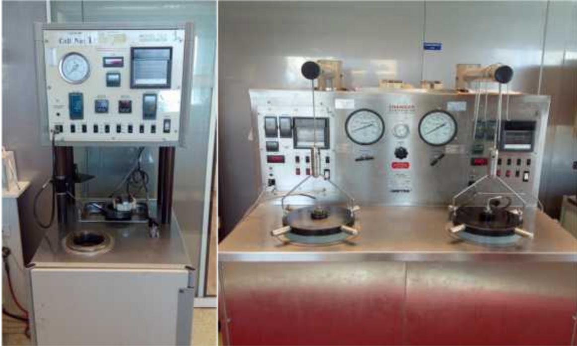
Figure (21) : Consistomètre pressurisé
