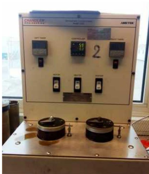
Figure (16) : consistomètre atmosphérique.
