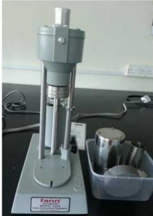
Figure (18) : rhéomètre de FANN
