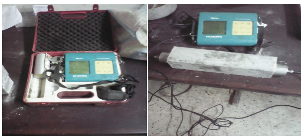
Fig.11: Essai d'auscultation sonique des bétons autoplaçants à 28jours.
