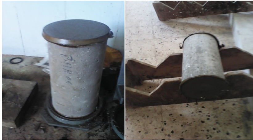
Fig . 12 Surfaçage des éprouvettes cylindriques (16x32) cm
