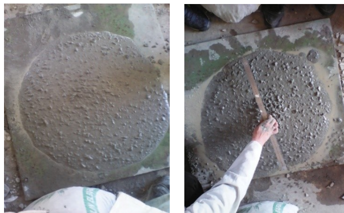
Fig.13 Essai d'étalement au cône d'Abrams.
