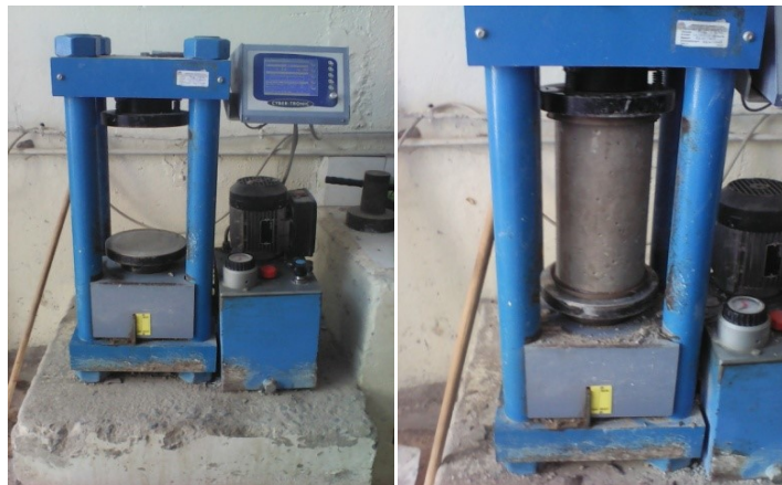
Fig.19 Essai de compression
