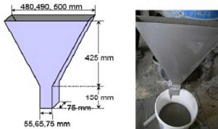
Figure I. 8 : Essai à l'entonnoir [20]
