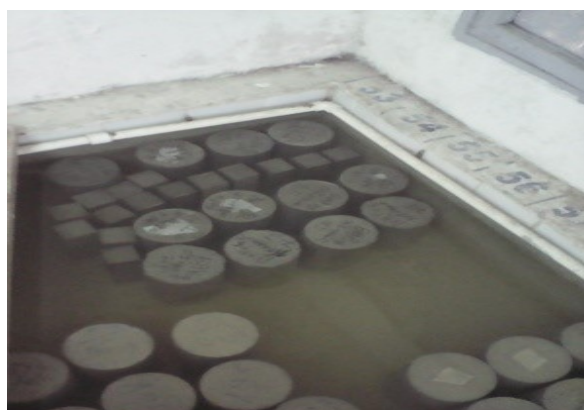
Fig. 10 Conservation des éprouvettes dans un bac d'eau à une température ambiante.
