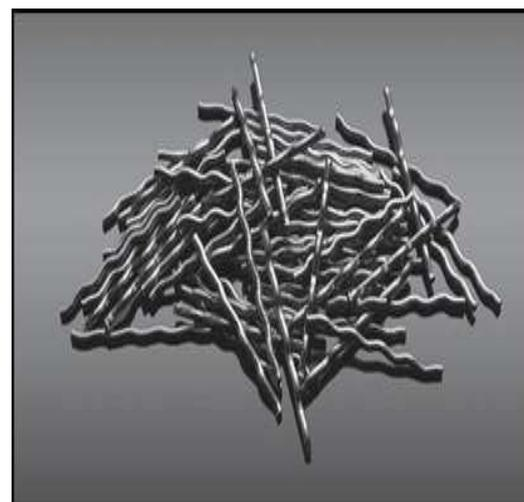
Figure 2 : Les fibres métalliques.
