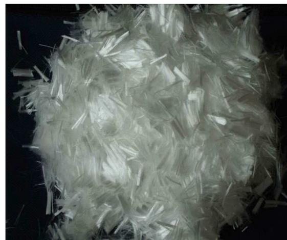
**Figure 4 :** Les fibres de polypropylènes.
