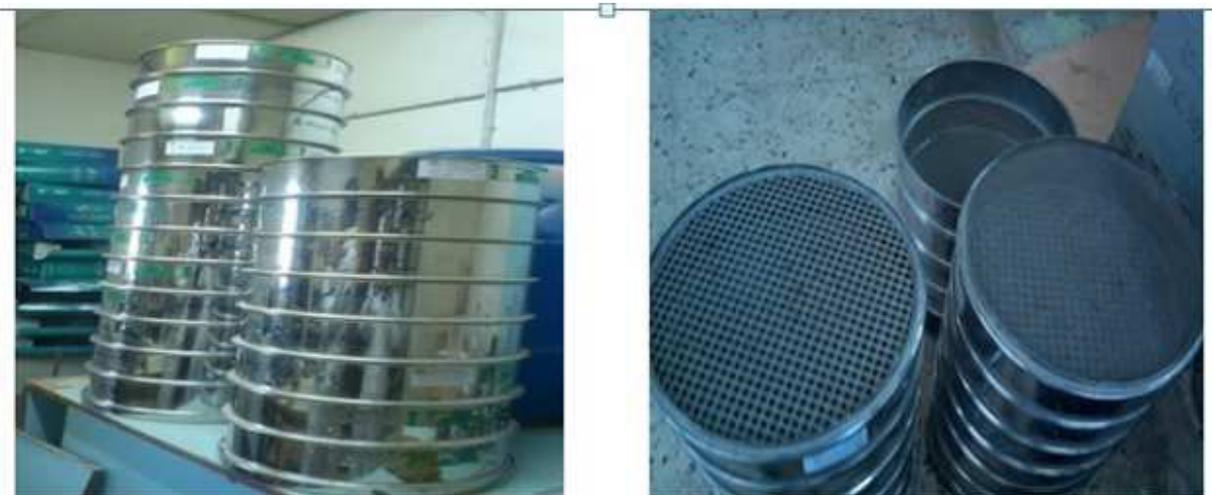
**Figure 7 :** Série de tamis en millimètres
