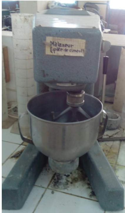
Figure IV.1. Malaxeur pour des portiers autoplaçants (MAP).
