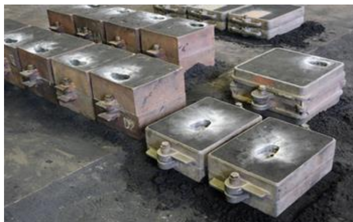
Figure II.3 : les moules au sable
