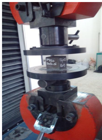
Figure V.5 : L'essai de compression uni-axiale
