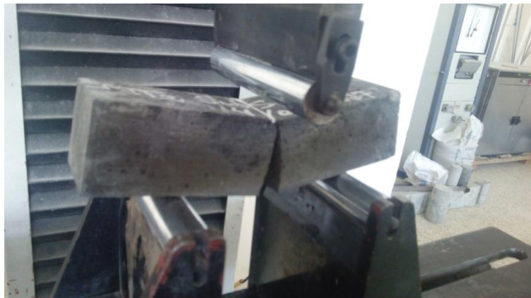
Figure V.4 : Essai de traction par flexion
