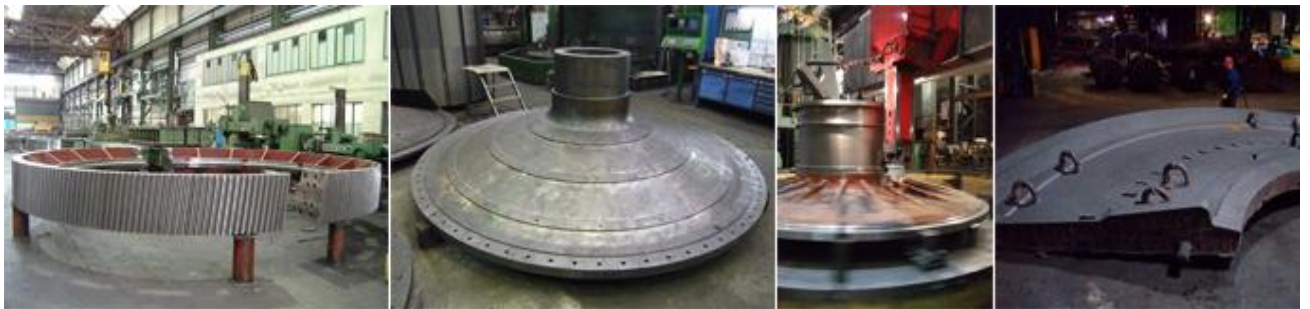
Fig. II. 2 : les pièces pour moulage au fer et acier
