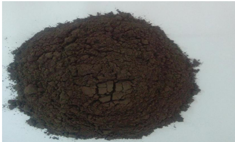
Figure III. 3 : Déchet de sable fonderie utilisé dans cette étude
