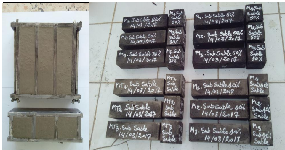
Figure IV.3 : Confection des éprouvettes du mortier autoplaçant
