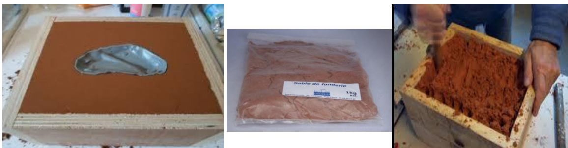
Fig. II. 1 : Moule au sable
