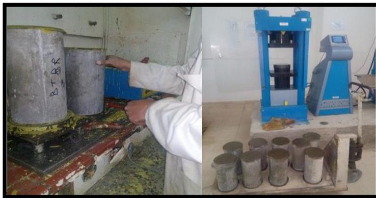
**Figure 21.** Surfaçage des éprouvettes de béton.
