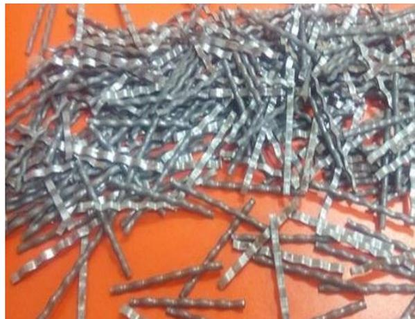
**Figure III.2.** Fibres métalliques ondulées (50mm).
