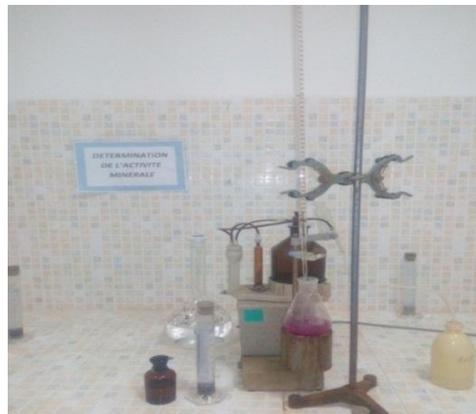
**Figure III.8.** Essai de détermination de l'activité pouzzolanique
