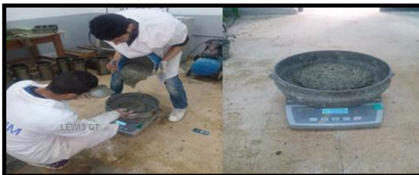
**Figure 16.** Essai de stabilité au tamis.
