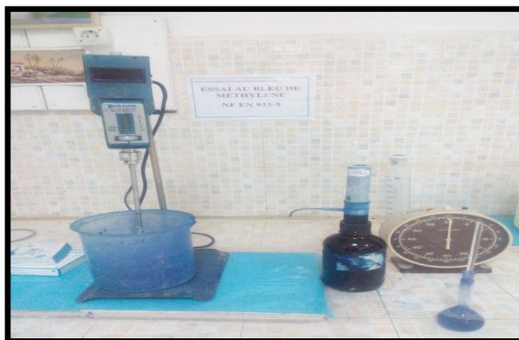
**Figure 4.** Essai de bleu de méthylène.
