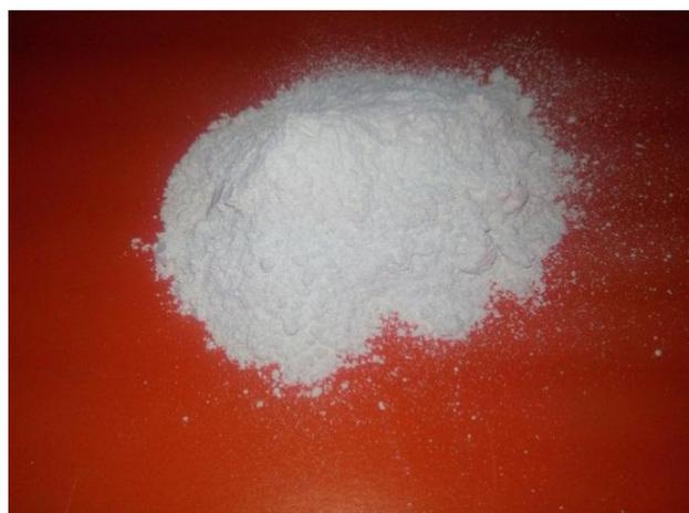
**Figure III.4.** Filler calcaire.
