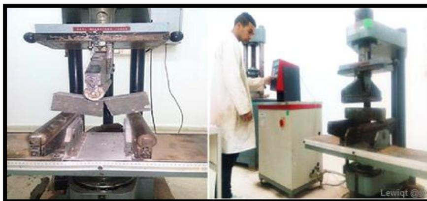
**Figure 23.** Essai de traction par flexion.
