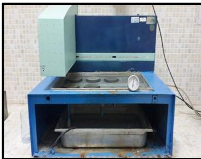
**Figure 9.** Appareil de Vicat muni par l'aiguille.
