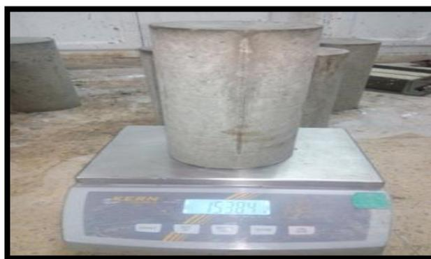
**Figure 20.** Mesure de la masse volumique à l'état durci.
