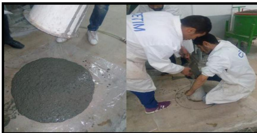
**Figure 14.** Essai de l'étalement.
