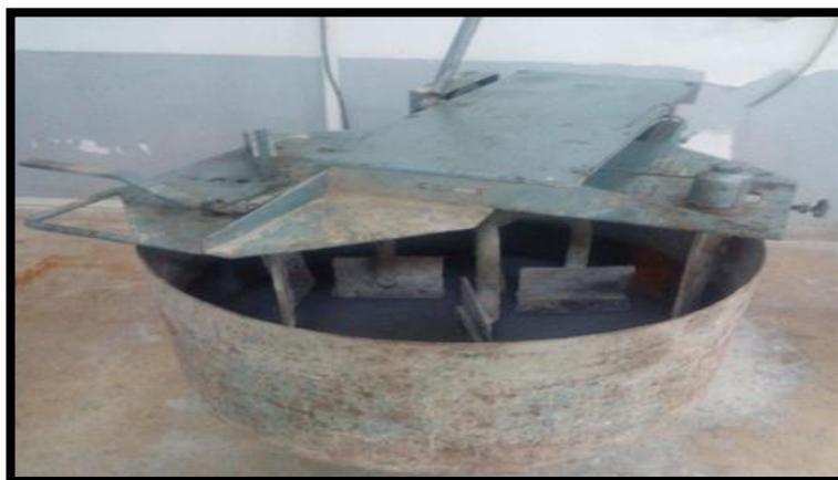
**Figure 13.** Malaxeur de béton.
