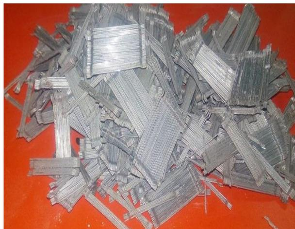
**Figure III.3.** Fibres métalliques crochées.
