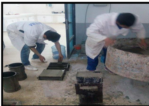
**Figure 18.** Remplissage des éprouvettes.
