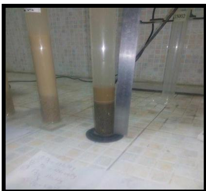
**Figure 2.** Dispositif de l'essai d'équivalent de sable.
