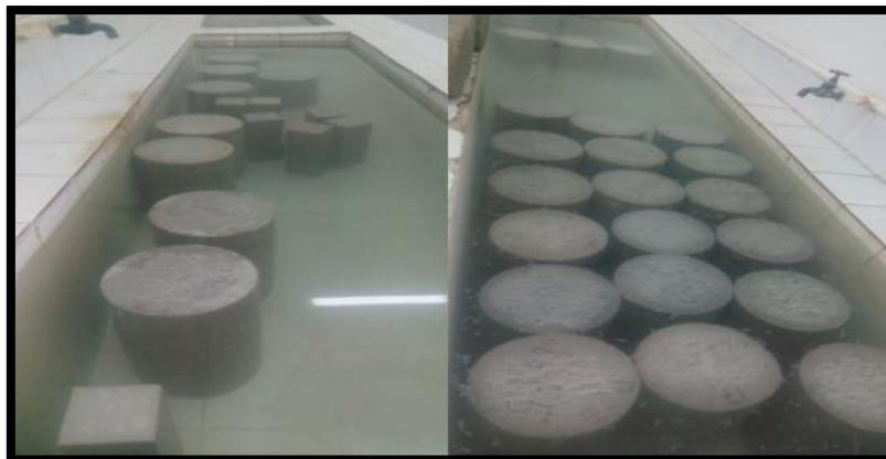
**Figure 19.** Conservation des éprouvettes dans un bac d'eau.
