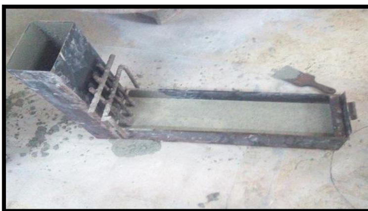
**Figure 15.** Essai de la boîte en L.
