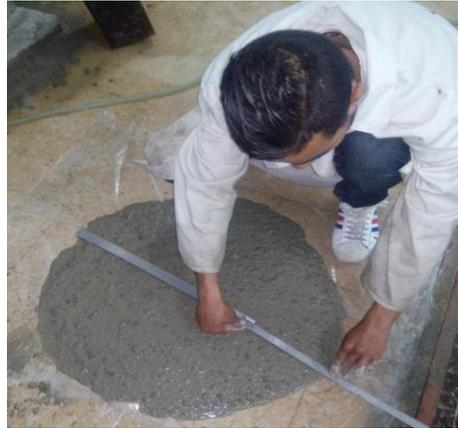
**Figure I.4.** Essai d'étalement.
