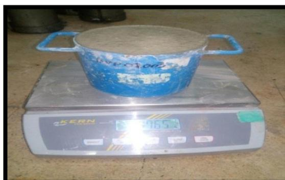
**Figure 17.** Mesure de la masse volumique des bétons à l'état frais.
