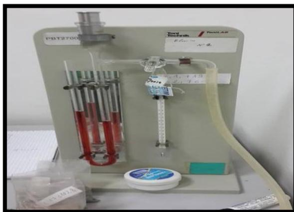
Figure 10. Perméabilimètre de Blaine.
