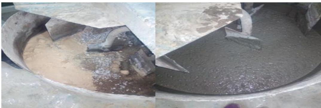
**Figure I. 1.** Béton autoplaçant avant et après le malaxage.
