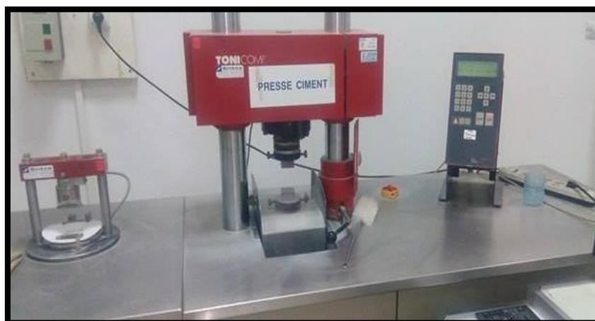
**Figure 12** : A gauche la machine d'essai de résistance à la flexion, et à droite la machine d'essai à la compression pour le mortier.
