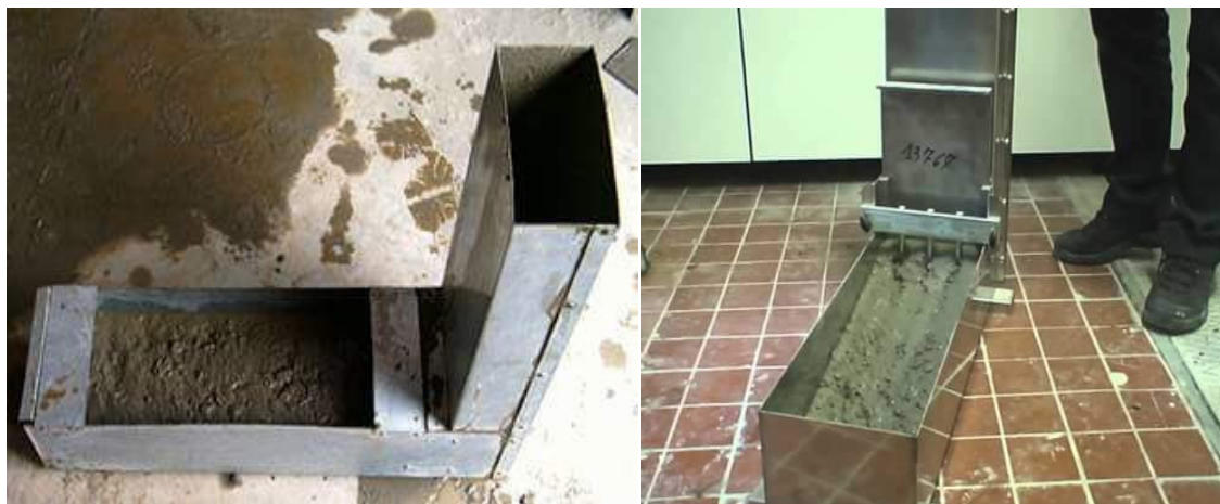
Figure III.8 : Essai de boîte en L.
