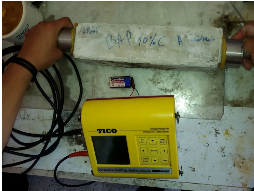
Figure III.12 : Essais de l'ultrason.
