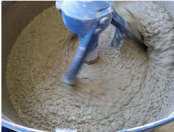
Figure III.2 : malaxage du béton.
