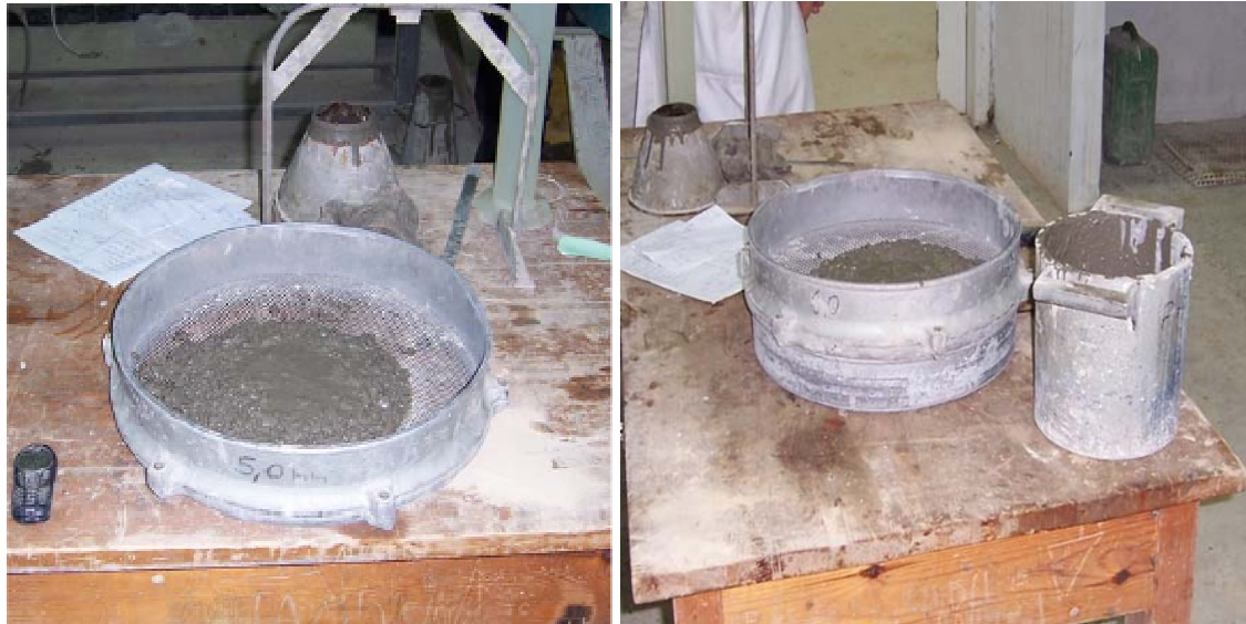
Figure III.9 : Essai de stabilité au tamis.
