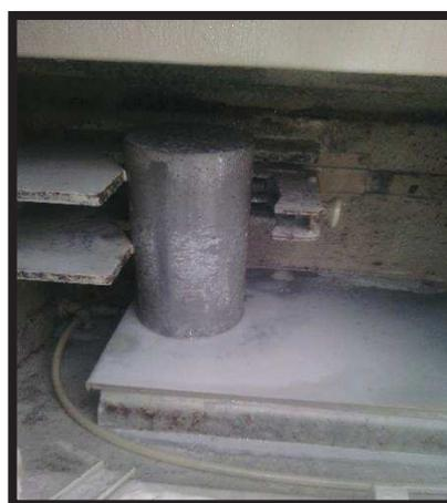
**figure IV.4 :** éprouvette à réctifier
