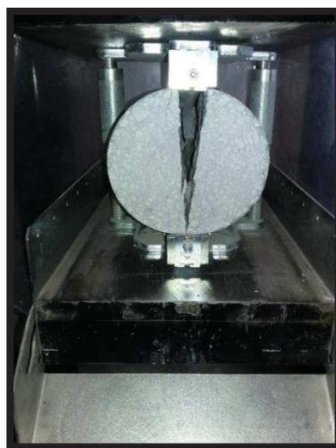
Figure IV .2 : une éprouvette soumise à l'essai de fendage
