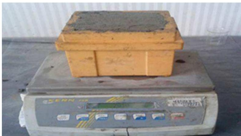
**Figure IV. 2** : mesure de la masse volumique.
