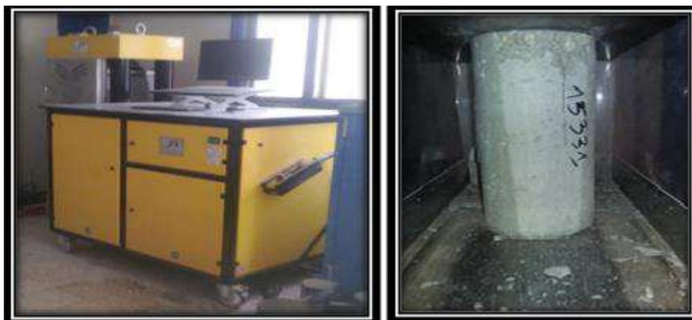
Figure IV.10 : appareil de compression
