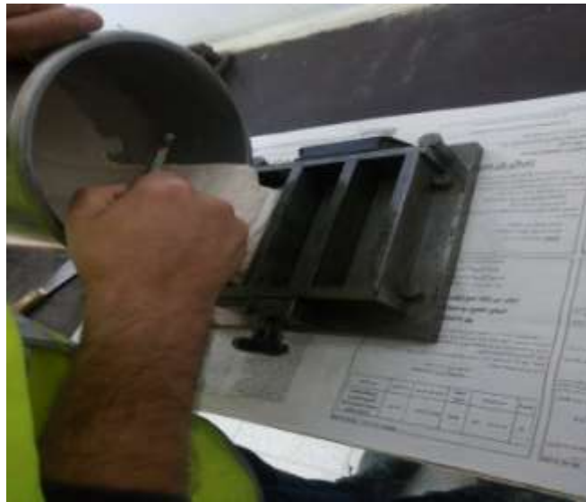
FigureII.5 : remplissage des éprouvettes.
