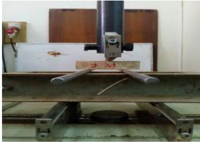
FigureII.9 : essai de flexion
