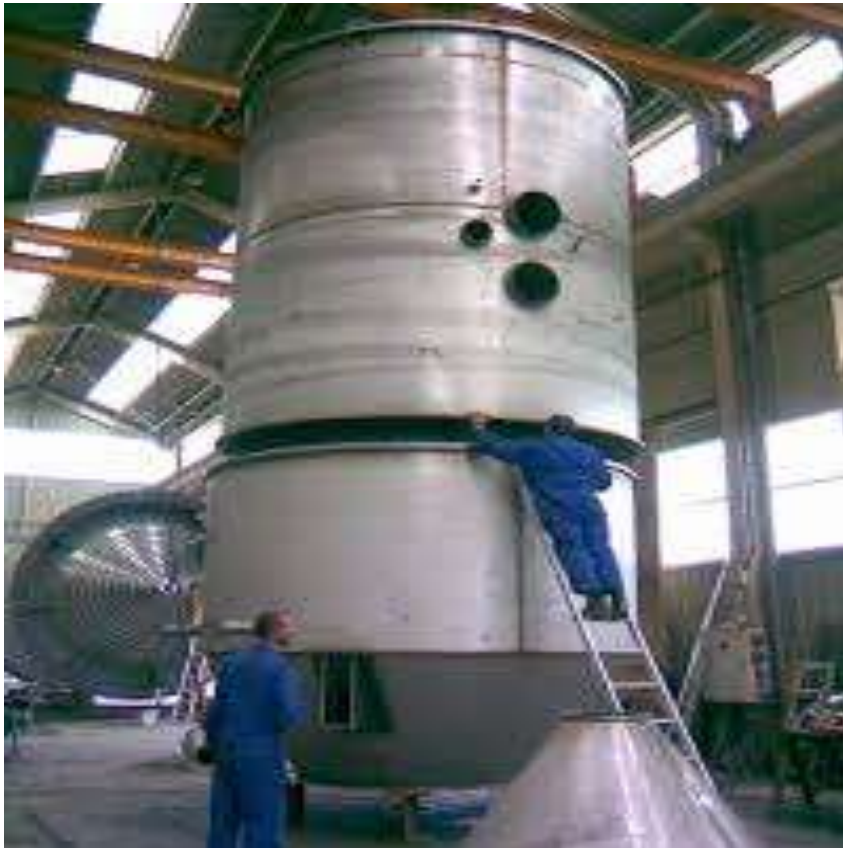
Figure I.9 : four de cuisson du gypse
