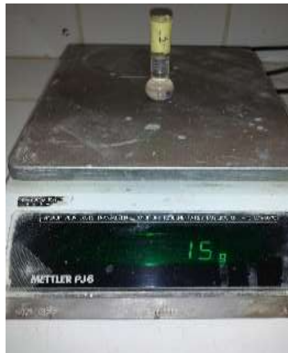
Figure II.10 : mesure de la masse spécifique
