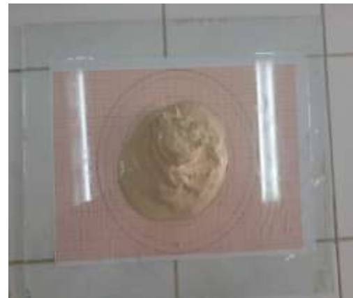
FigureII.2 : détermination de la consistance normale.
