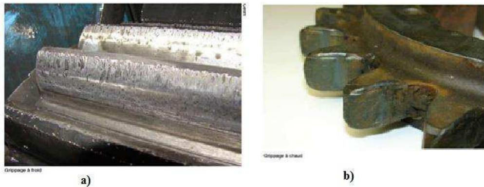
Fig.3.14. Le grippage Engrenage.
