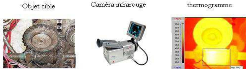
**Fig.2. 2.** Exemple de la thermographie infrarouge
