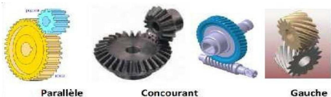
Figure IV.39. Différents types d'engrenage
