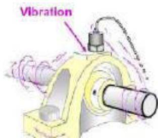
Figure IV.14. Fixation d'un capteur sur palier
