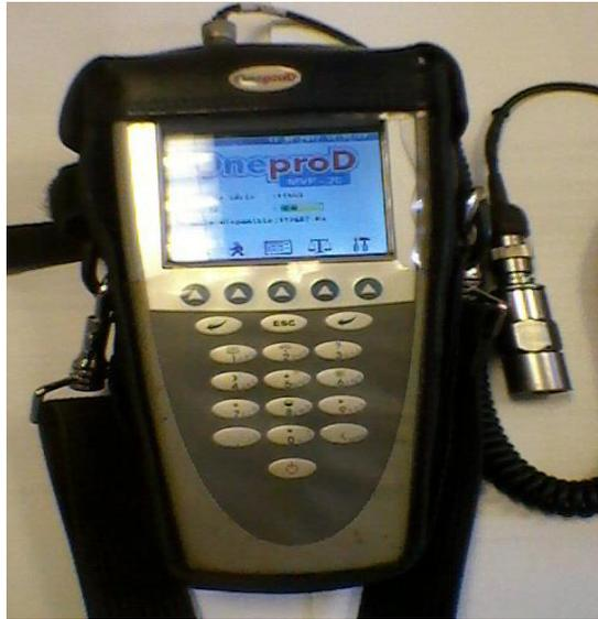
Figure V.2. Analyseur MVP-200
