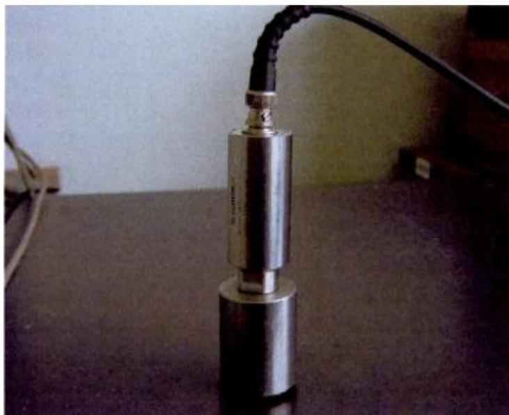
Figure V.4 : Accéléromètre.
