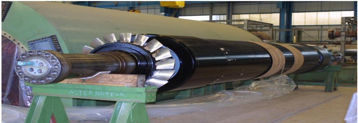
Figure I.8 : Photo de partie mobile de la machine (l'inducteur).
