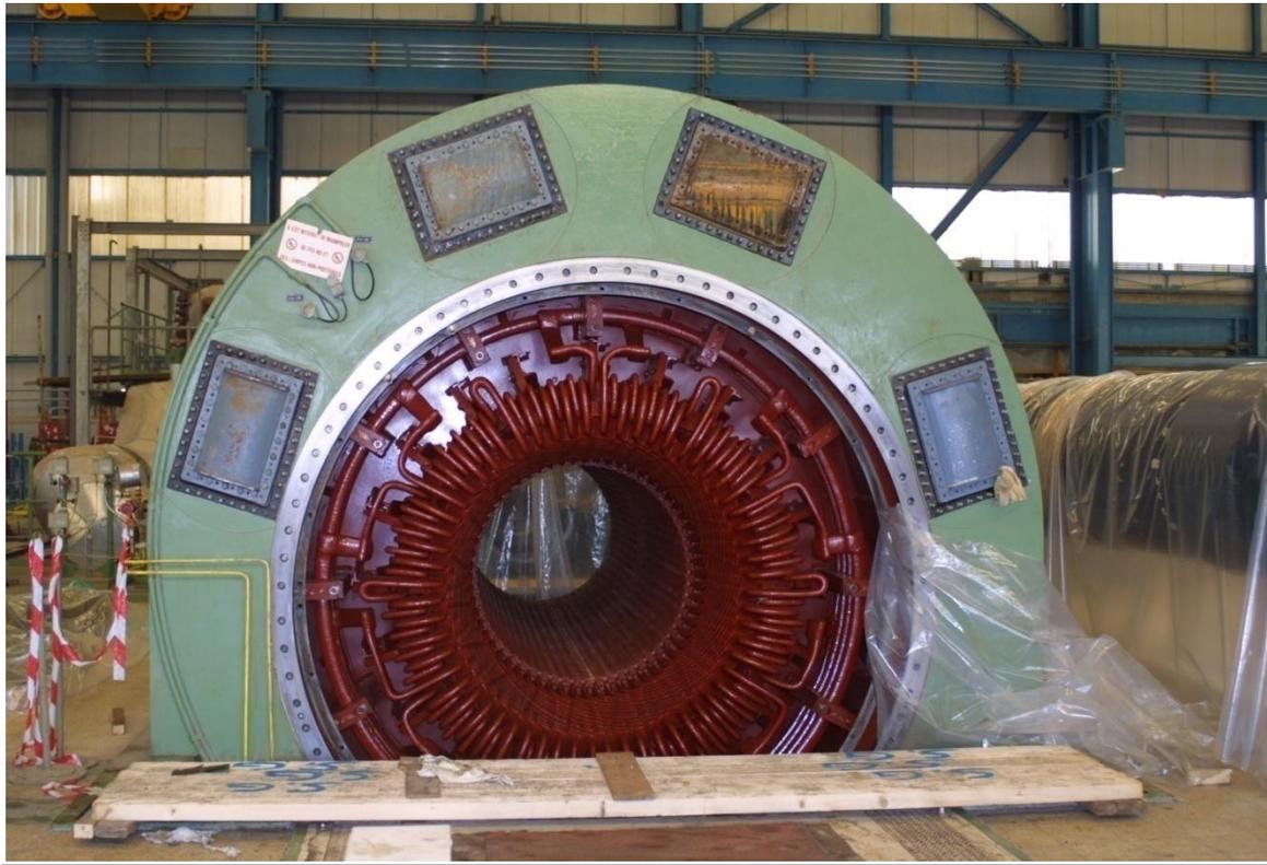
Figure I.9 : Photo de partie fixe de l'alternateur (l'induit).
