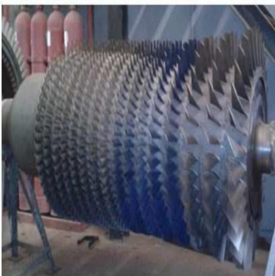
Rotor du compresseur axial
