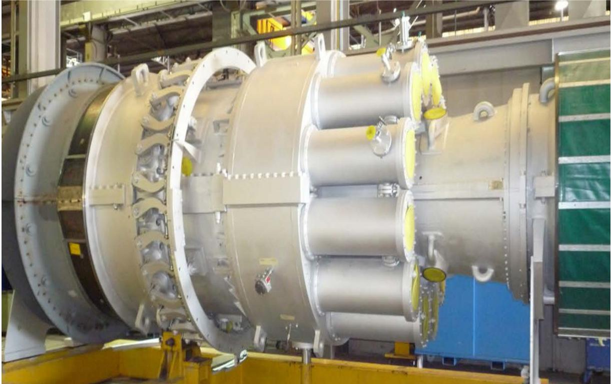
**Figure III.6.** Section combustion (12 chambres de combustion).
