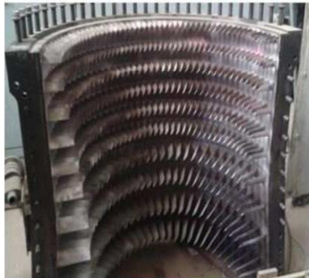
Stator du compresseur axial
