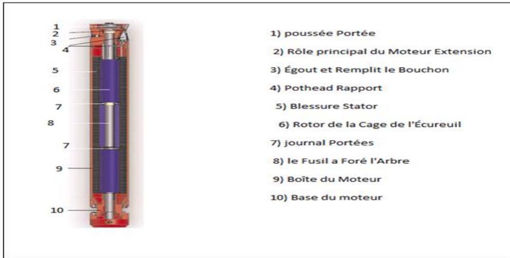
Figure VI.19 : moteur électrique d'une pompe ESP
