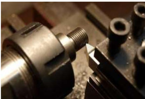
Figure V. 14. Opération de filetage.
