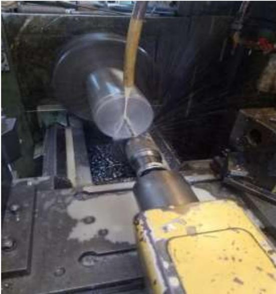
Figure V. 16. Opération de perçage (notre travail eu niveau des ateliers).
