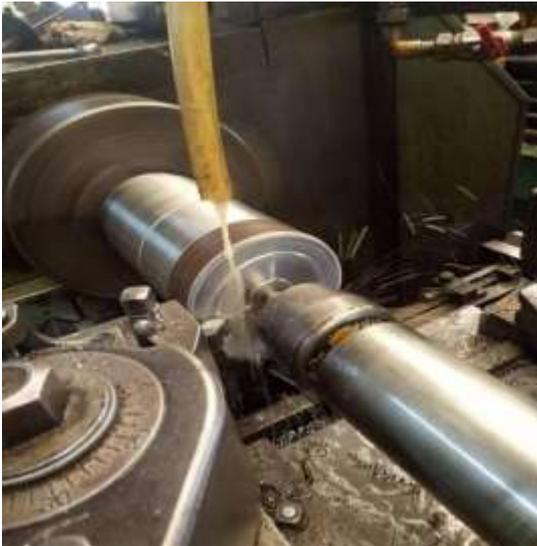
**Figure V. 4.** Opération de dressage (notre travail eu niveau des ateliers). **Figure V. 5.** Outil de dressage.
