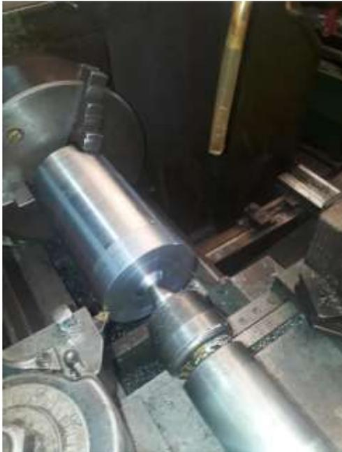
**Figure V. 8.** Opération de chan freinage
