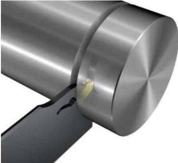
Figure V. 12. Opération de tronçonnage.
