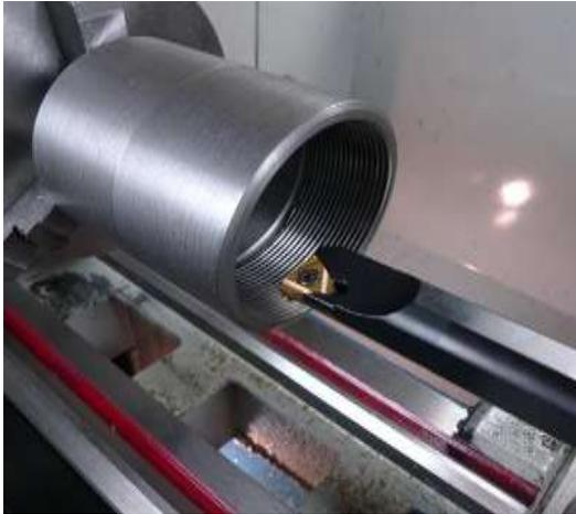
Figure V. 20. Opération de taraudage.
