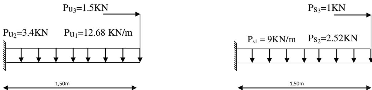
**Figure 3.19 :** Schéma statique de balcon.
