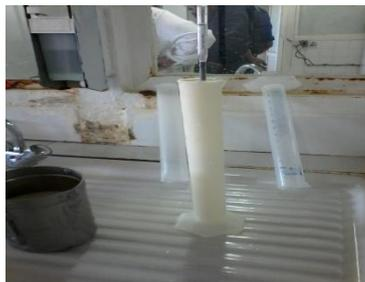
**Figure 22 :** photo de détermination de la densité du lait
