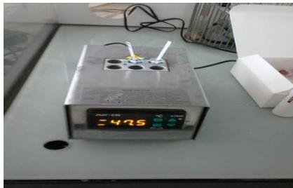
**Figure 31:** photo de détermination de résidus d'antibiotique dans le lait cru.
