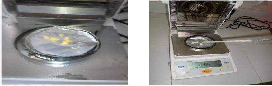
**Figure 25** : photos de détermination de l'extrait sec total dans le lait et le fromage
