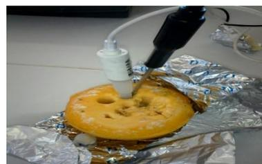
**Figure 21 :** photos de détermination du pH de lait et du fromage
