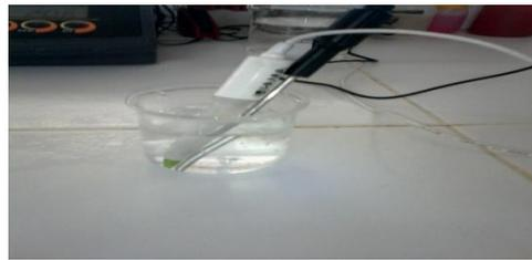
**Figure 26** : photo de détermination du pH de l'eau
