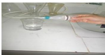
**Figure 27** : Photo de la détermination du titre alcalimétrique simple (TA)
