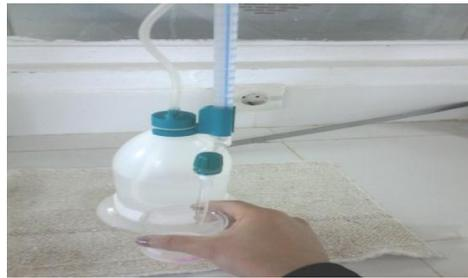
**Figure 20:** photo de détermination de l'acidité titrable du lait
