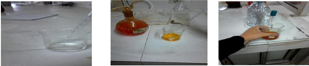
**Figure 30** : photos du dosage des chlorures (méthode MOHR)
