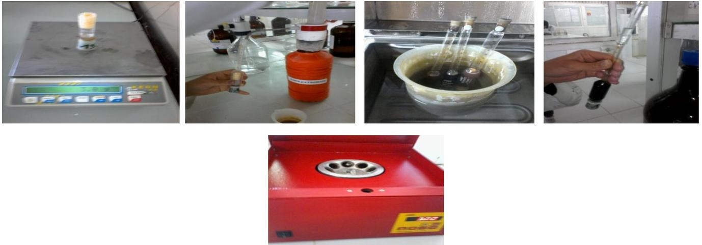
**Figure 24:** photos de détermination de la matière grasse du fromage.
