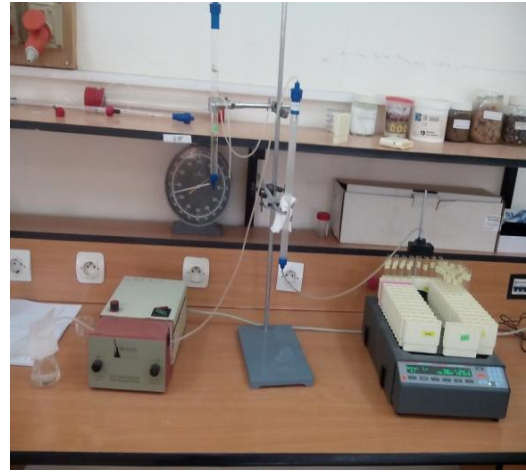
Installation du gel filtration
