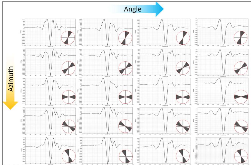
Figure V.27 : Ondelettes moyennes tirées à partir des deux puits, aux différents azimuts et angle-stacks.
