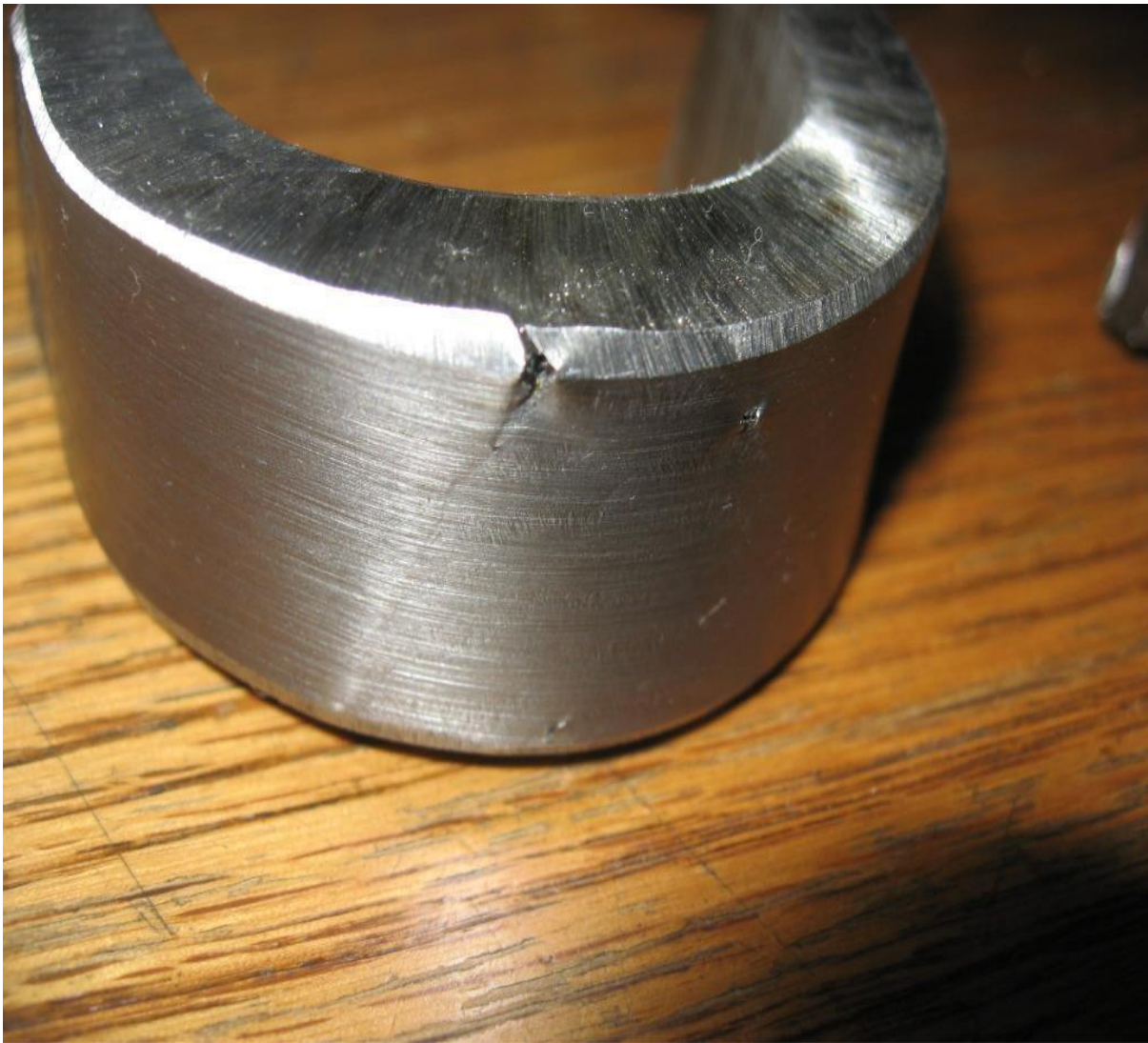
Figure IV, 21 : Les défauts révélés d'une éprouvette après l'essai de pliage à l'endroit
