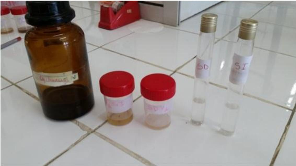
**Photo montrant les conditions d'analyse des huiles dans l'UV : Echantillons d'huiles analysées (SD et SI), solvant utilisé (cyclohexane) et solution prête pour analyse (éprouvettes SD et SI).**
