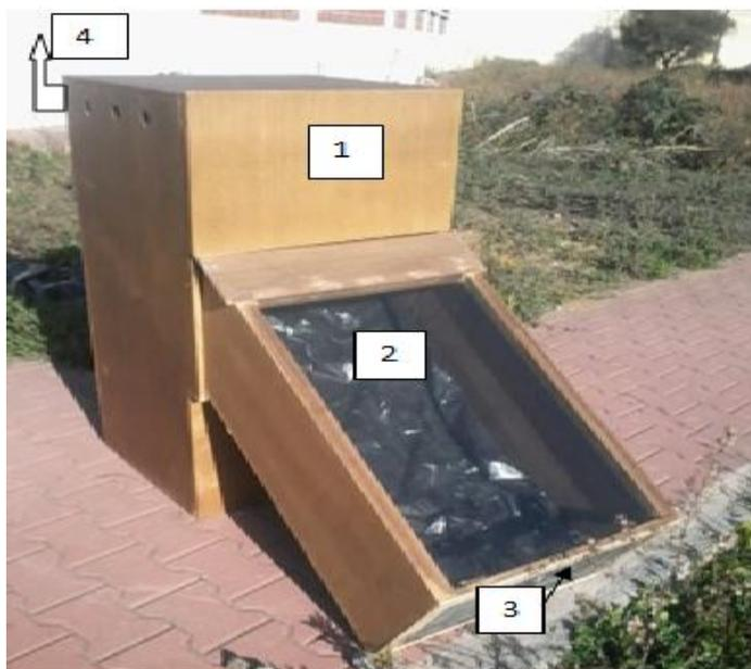
1- Cabine de séchage munie de claies sur lesquelles les olives sont déposées
