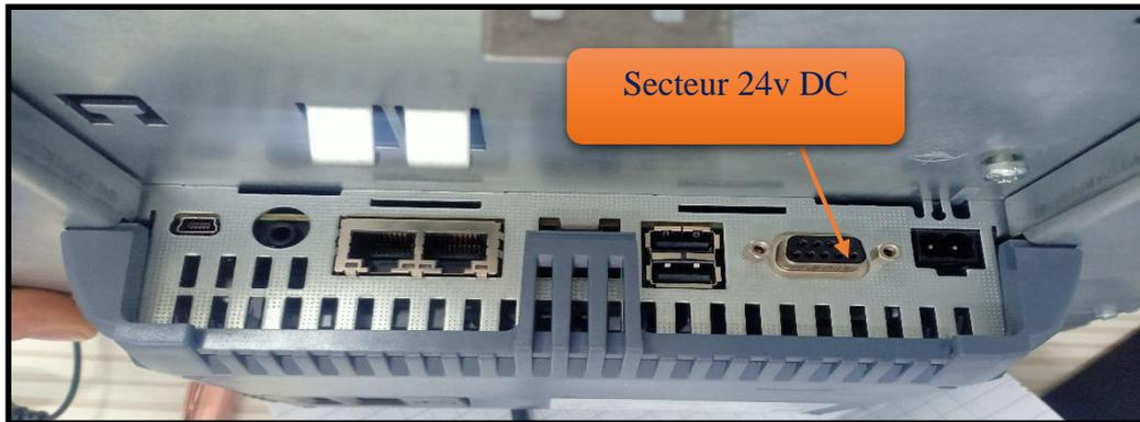
**Figure V. 25 :** Sélecteur HMI TP1200comfort 24v, DC
