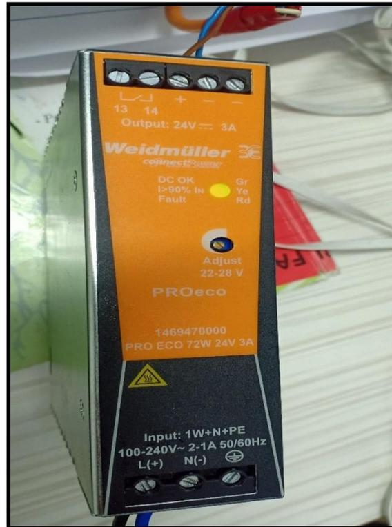
**Figure V. 26 :** Convertisseur WINDMULLER AC /DC ,1220W,24V ,5A
