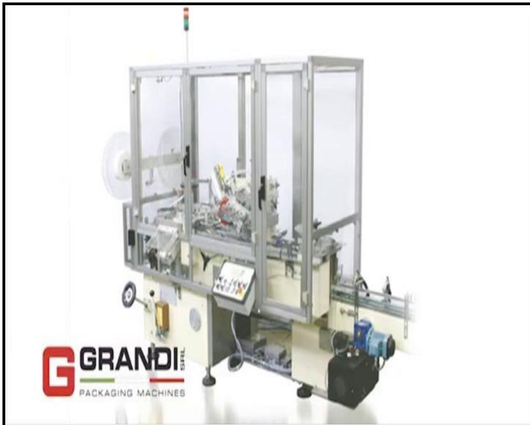
Figure I. 5 : Machine de pose de bandeau automatique
