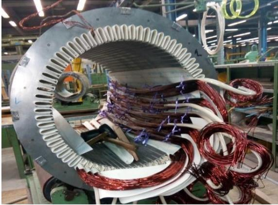
Figure I. 21: Stator avec caniveau d'encoche isolés
