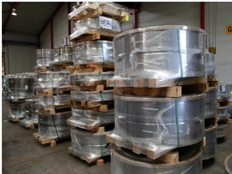
**Figure I. 3: Rouleaux de tôle magnétique**
