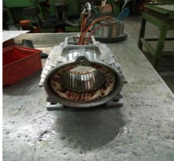
Figure I. 23: Pré montage du stator dans la carcasse    Figure I. 24: stator bobiné monté dans une carcasse
