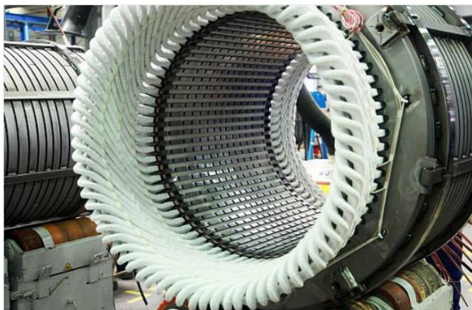
Figure II. 15: Image d'une isolation d'encoche
