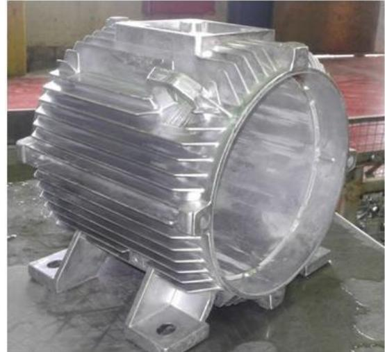
Figure I. 14: Carcasse métal coulé(Aluminium)
