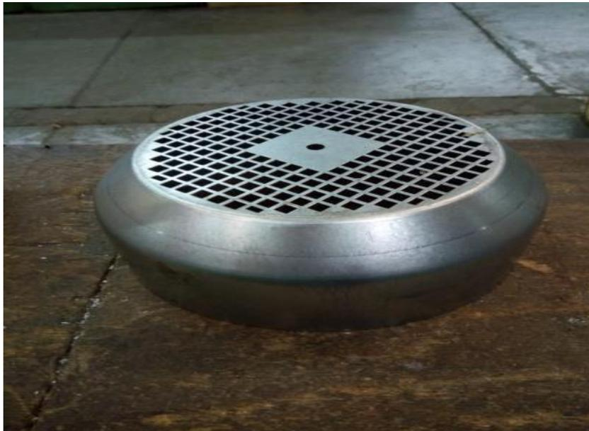
Figure I. 8: Capot de ventilateur
