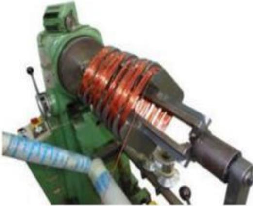
Figure I. 19: Bobineuse de fil électrique
