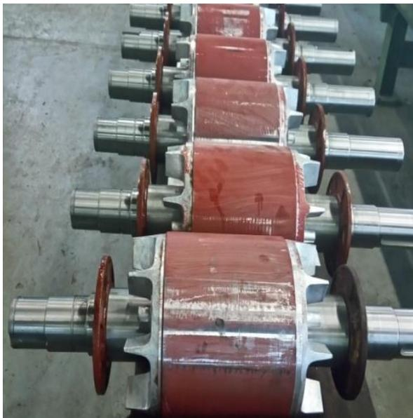
Figure I. 11: Rotor à cage moulé
