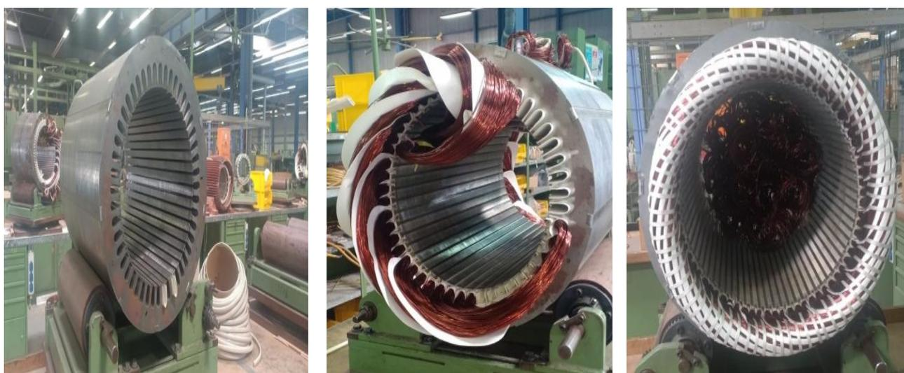
Figure III. 1: Moteur asynchrone à double cage d'écureuil 250 kW
