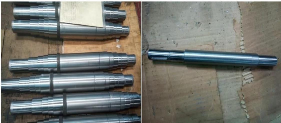
Figure I. 9: Arbre d'un moteur électrique après usinage
