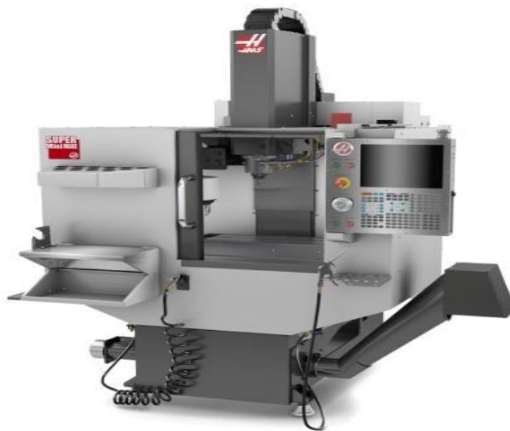
**Figure III.3 :** La machine CNC Haas super mini Mill
