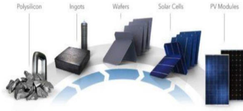
**Figure II.21:** étapes de fabrication d'un panneau solaire
