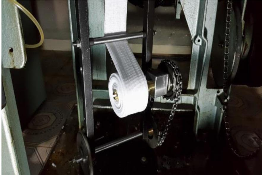
Figure. 2.1. Métier à tricoter circulaire Bentley komet transformé pour produire La bande jersey simple continu. Photo Ali Bey H. Alger.
