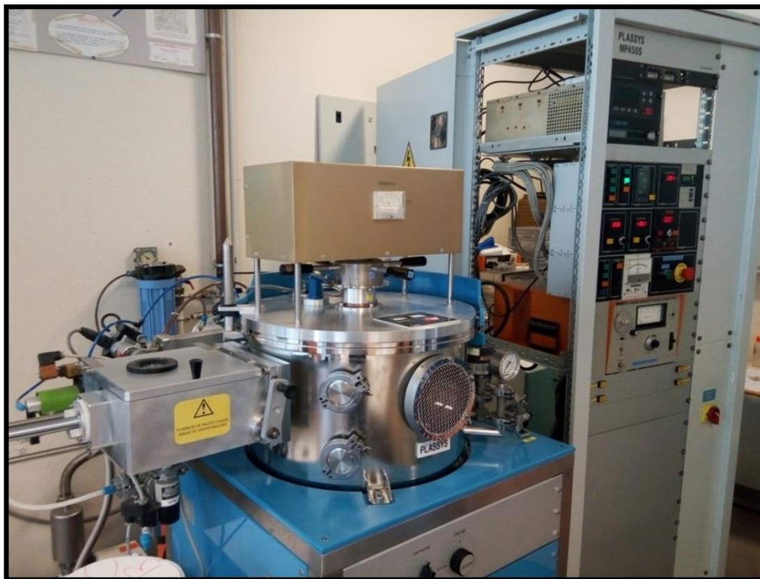
Figure 18. Une pulvérisation cathodique radiofréquence magnétron de l'IETR sur le site de Saint Briec « PLASSYS MP 450S »
