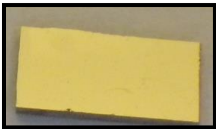
Figure 35. Une photo d’un film de Titane Ti avant le dépôt de TiN
