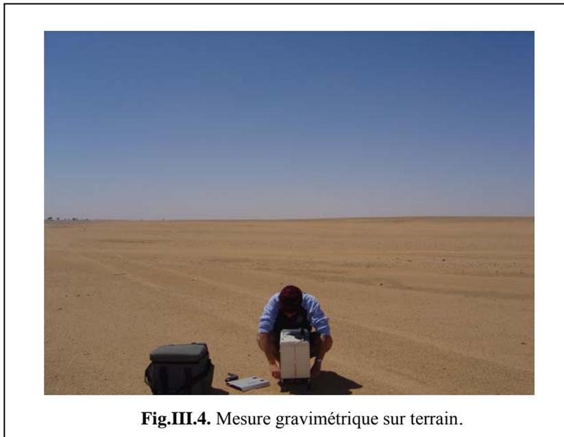
Après le nivellement de l'appareil par les niveaux galvanométriques et digitaux, les mesures sont faites automatiquement. Pour chaque mesure, un contrôle statistique est effectué, les valeurs jugées en dehors d'une certaine limite de sensibilité sont automatiquement éliminées. Les données numériques sont, alors stockées dans la mémoire du gravimètre.
