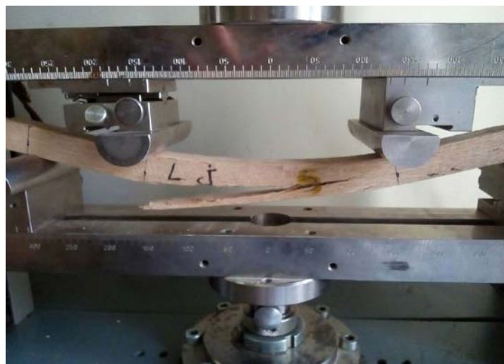
Figure A.7. Rupture des éprouvettes soumises à la flexion.
