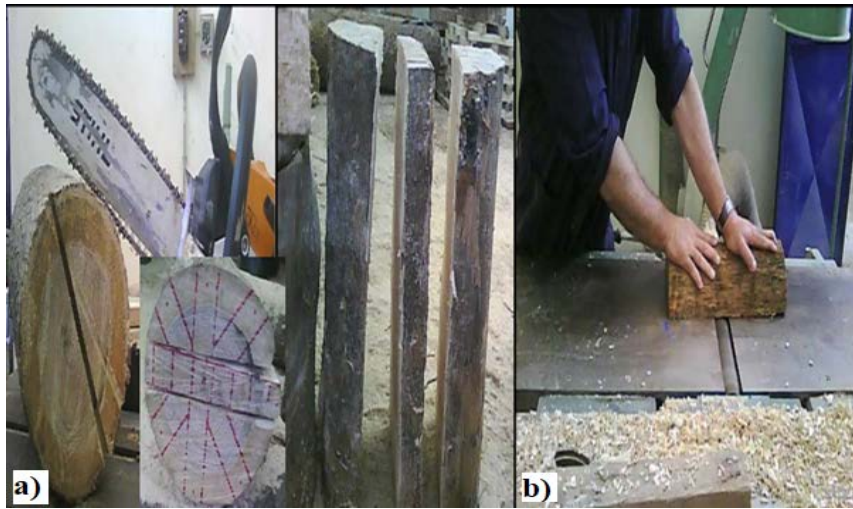
Figure A.3. Préparation des éprouvettes : a) découpage par scie à chaîne, b) coupe et rabotage)
