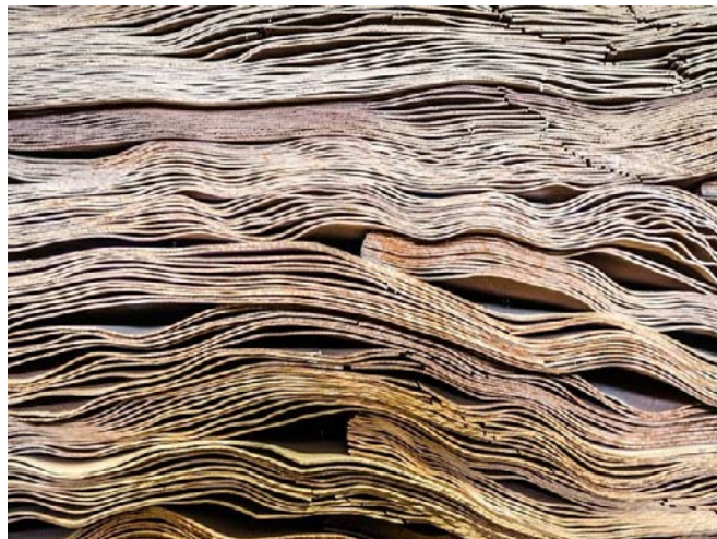
Figure A.19. Fissure apparaissant dans la feuille de placage.
