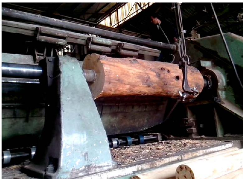
Figure A.17. Dérouleuse type : DNH27 de TRANS BOIS EPE/SPA Bejaia .
