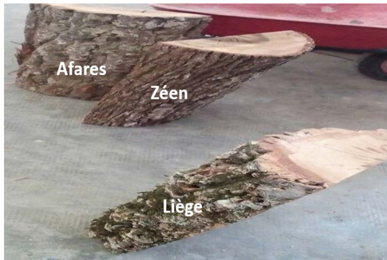
Figure A.2. Grumes du bois découpées de : chêne zéen, chêne afares, chêne liège.
