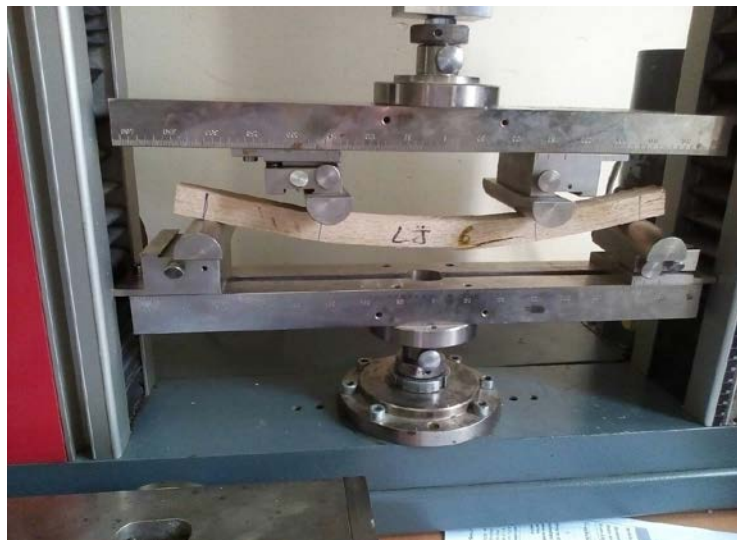
Figure A.5. Essai de flexion 4 points réalisé au laboratoire.
