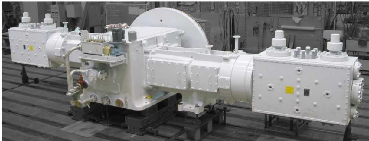
**Figure II.3** Compresseur alternatif à 2 étages.
