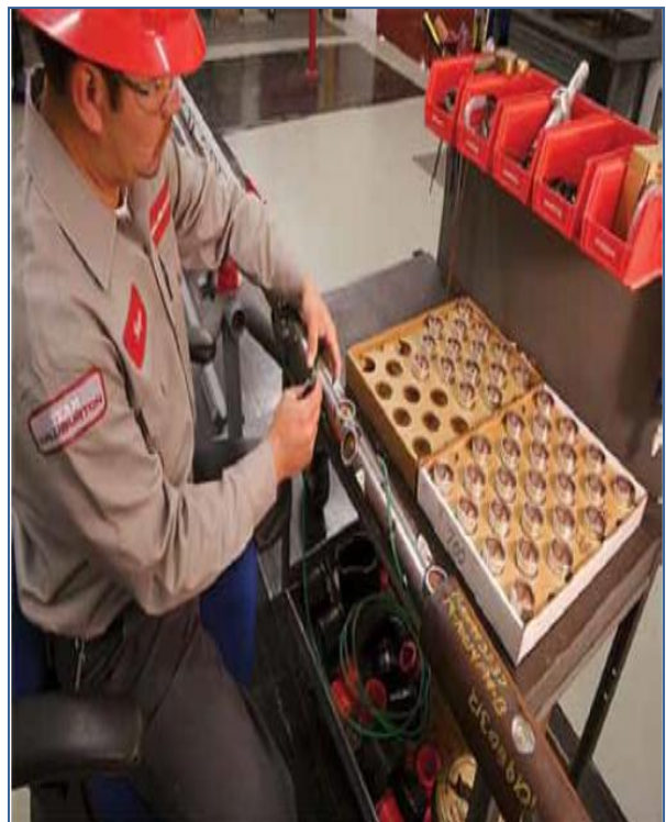
Fig.3 : Préparation de l'outil de perforation (SCGNC, revue)
