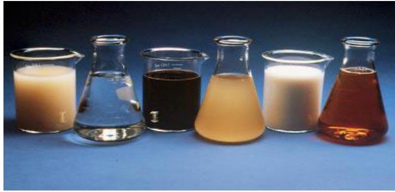
Figure I.1: Adjuvants liquids de gauche à droite : agent anti-lessivage , réducteur de retrait , réducteur d'eau ,agent moussant ,inhibiteur de corrosion et agent entraîneur d'air
