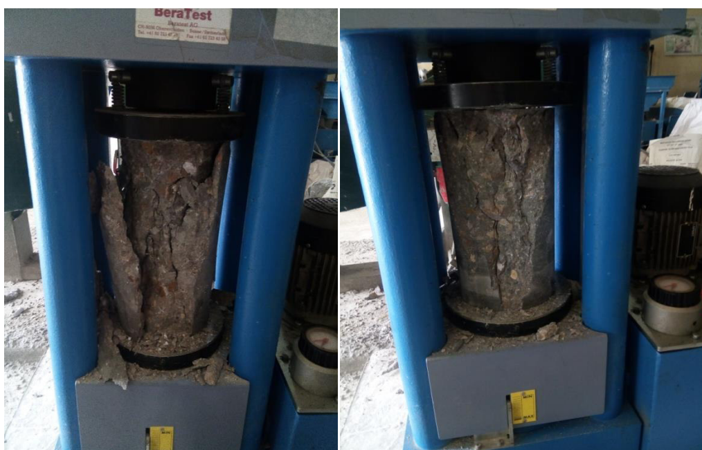
Figure IV.11 : Mode de fissuration des éprouvettes (7J.28J béton avec 20%PL).
