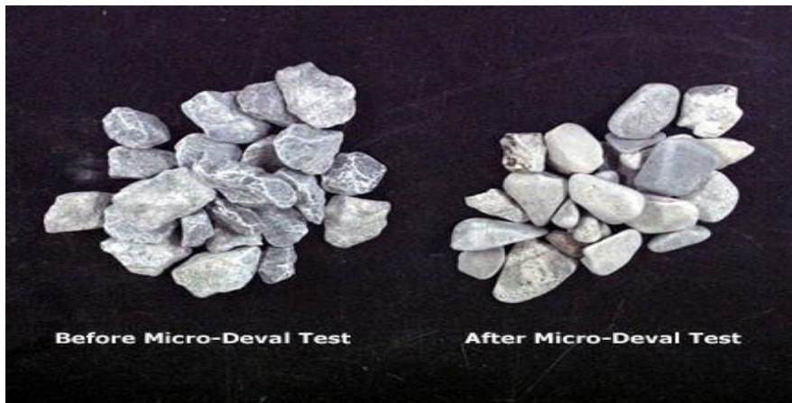
Figure 2 :L'échantillon avant et après l'essai
