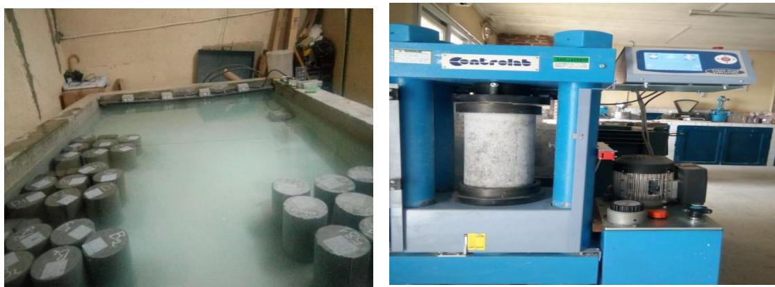
Figure IV.9: Conservation des éprouvettes dans l'eau potable (gauche), la presse de compression (droite).
