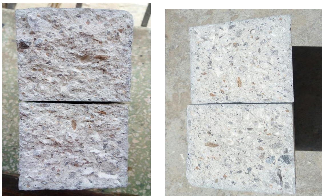
Figure IV.14 : vue macroscopique de la surface de rupture (epr ;7J.28J béton avec 20%PL).
