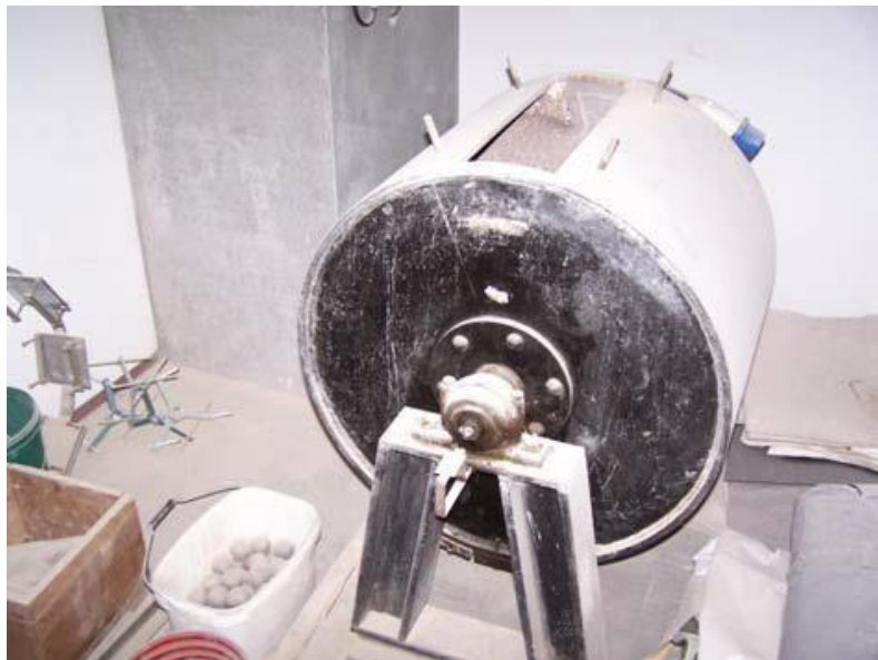
Figure 1 : Le tambour Los Angeles et les boulets
