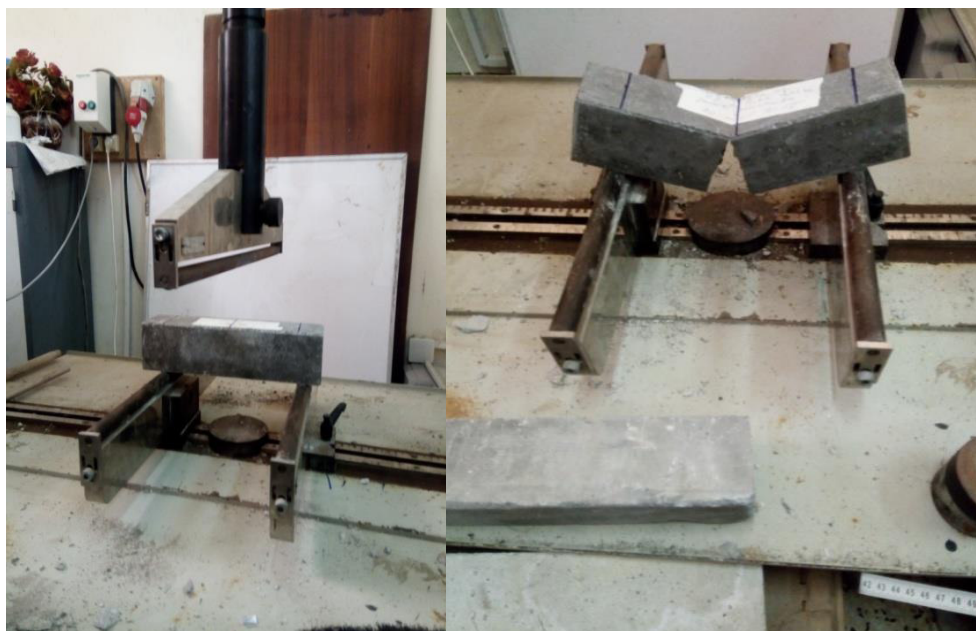
Figure IV.13 : Mode de rupture des éprouvettes (7J.28J béton avec 20%PL).
