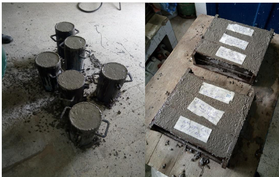
Figure IV.5 : Remplissage des éprouvettes.
