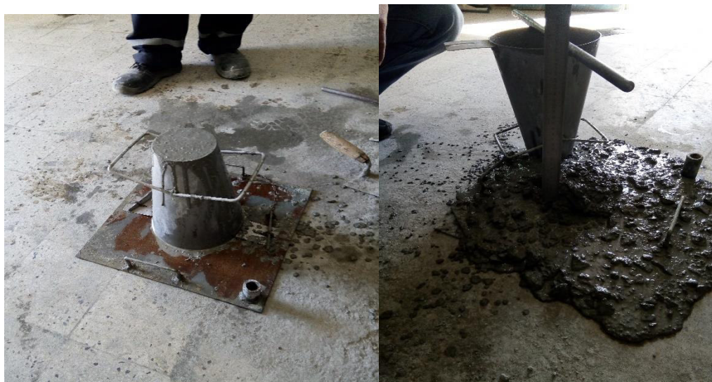
Figure IV.6 : L'essai d'affaissement (cône d'ABRAMS)
