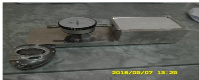
Figure II .7. Appareil de détermination de l'expansion
