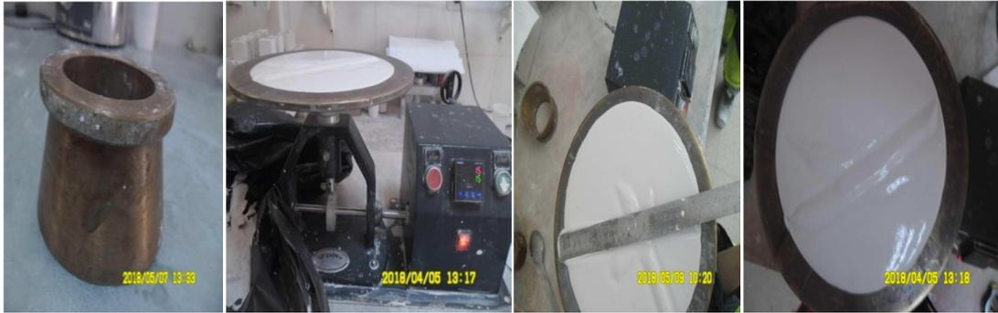
Figure III .1 .Les étapes de détermination deE/P par la table à secousses
