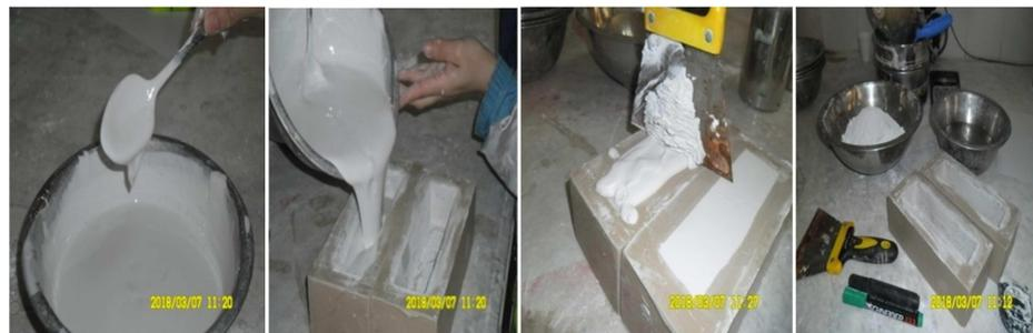
FigureII.8 .Préparation des éprouvettes
