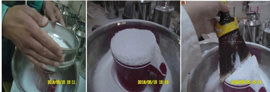
Figure II.3. Détermination de la masse volumique non tassé
