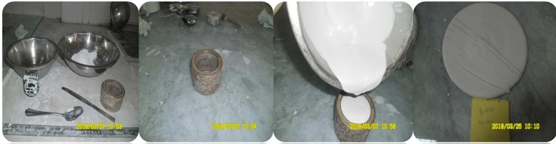
Figure II .6. Déroulement de l'essai d'étalement
