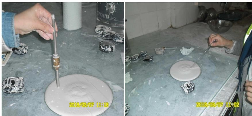
**Figure II.5.** Détermination des temps de prise**II.2.5.3. Test d'étalement aux anneaux**
