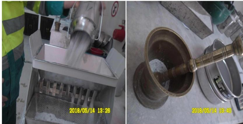
Figure II .1. Homogénéisation du gypse au laboratoire
