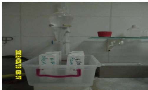
Figure II .11. Test d'absorption des éprouvettes
