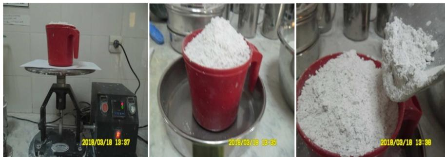
Figure II.4. Détermination de la MV tassé
