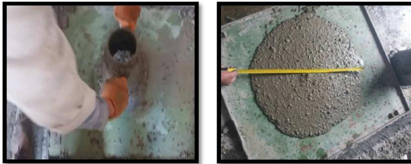
**Fig 3.4.**Essai de cône d'Abrams
