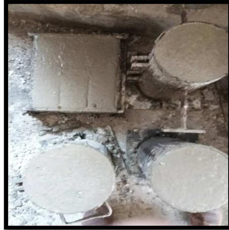
**Fig 3.2.** Moules de béton autoplaçant
