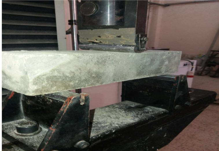
**Figure 3.18.** Machine d'essai de flexion
