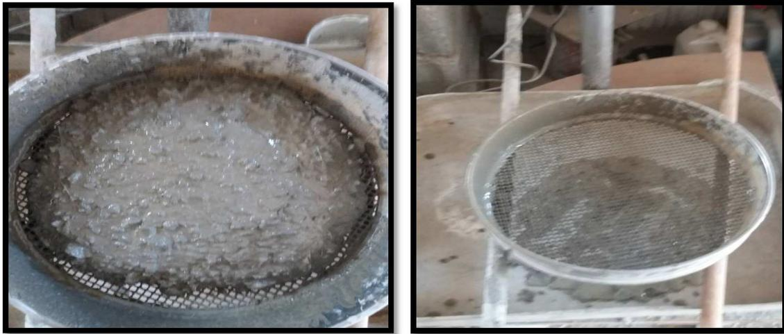
**Fig 3.12.** Essai de stabilité au tamis
