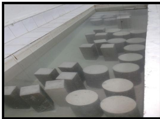
**Fig 3.3.** Conservation des éprouvettes
