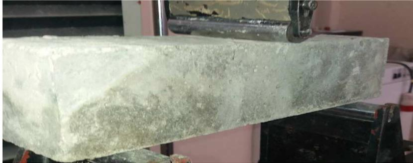
**Figure 3.29.** Densification des fissures et rupture ductile
