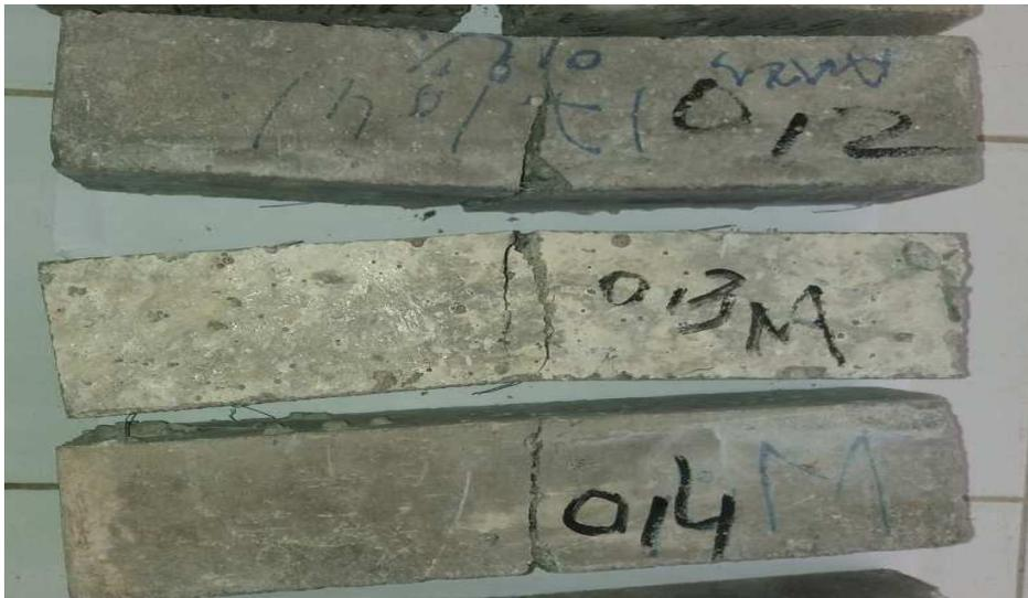
**Fig.3.28.a.**Mode de rupture ductile pour BAPFM1- BAPFM2- BAPFM3.
