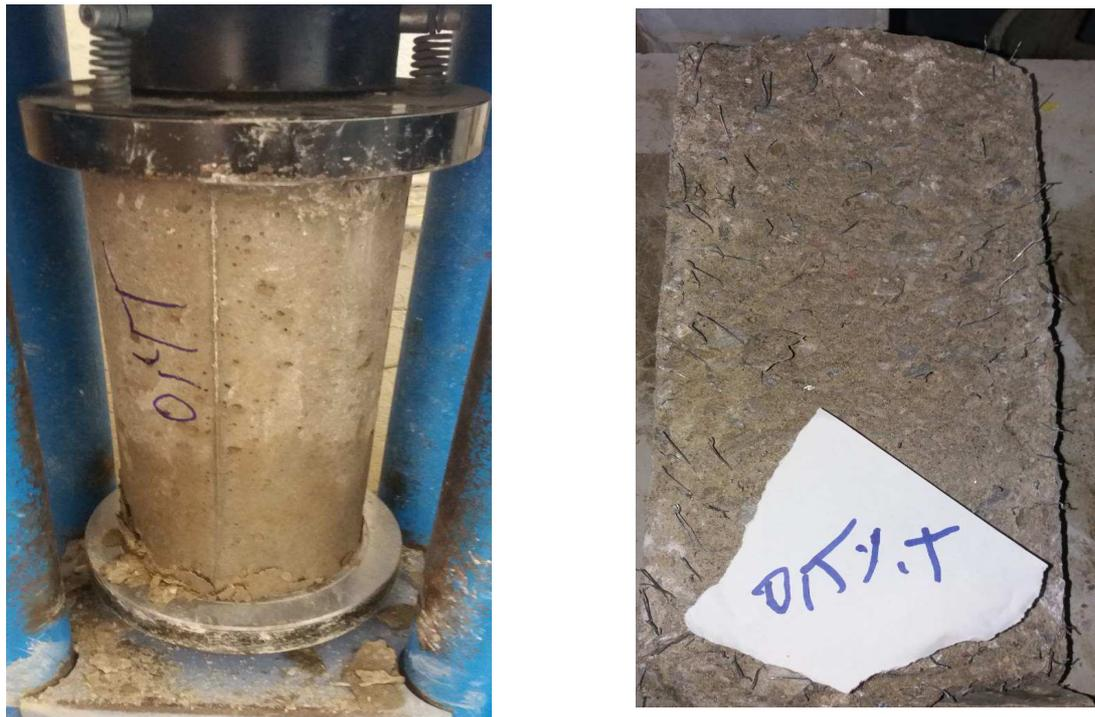
Figure 3.21. Mode d'essai et rupture de l'éprouvette
