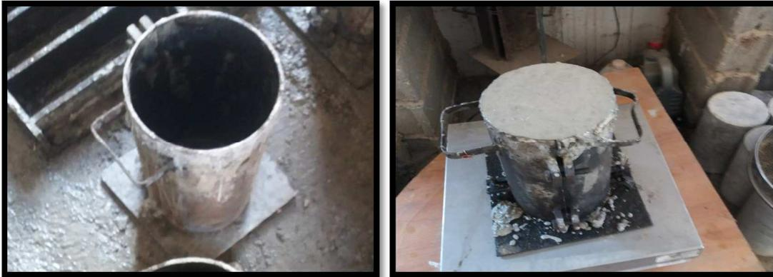
**Fig 3.15.** Essai de la masse volumique.
