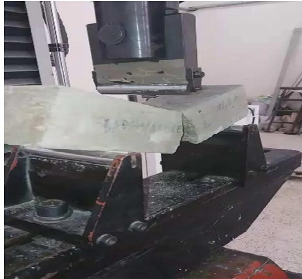
**Fig 3.26.**Rupture du béton témoin (Rupture fragile à mi-portée)
