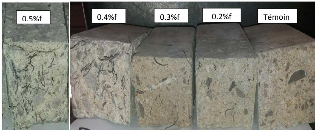
**Fig (3.19-b).**Répartition des fibres dans les bétons à base d'ajout de tuf
