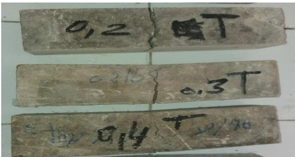
**Fig.3.28.b.**Mode de rupture ductile pour BAPFT1- BAPFT2- BAPFT3.
