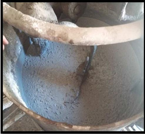
**Fig 3.1.** Malaxage de béton autoplaçant
