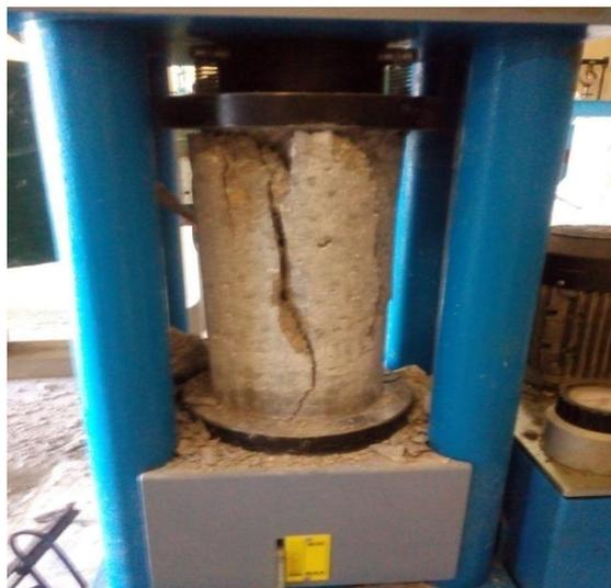
**Figure III.9 :** Le mode de rupture obtenu en compression
