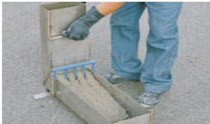
Figure I.12 : L'écoulement de BAP dans la boîte en «L»
