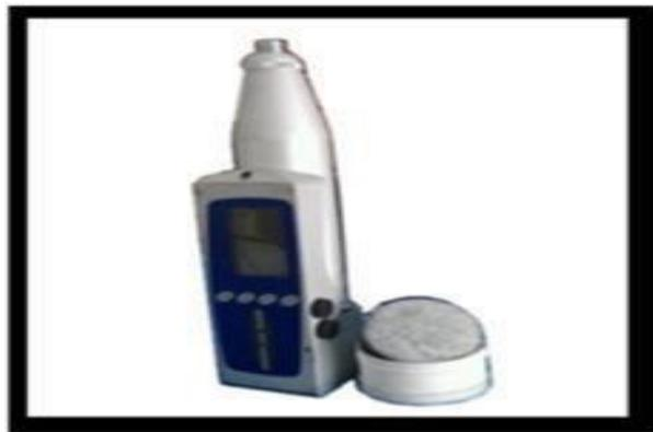
**Figure II.6 :** Appareil sclérométrique.
