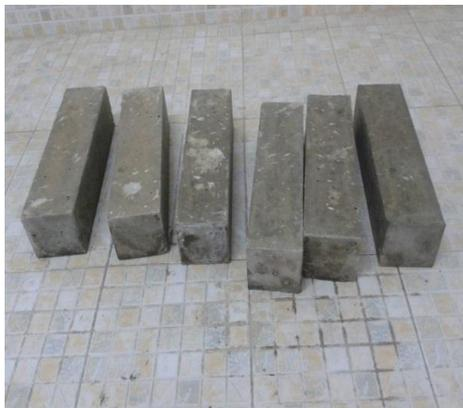
**Figure III.6 :** Eprouvettes d'essai de traction
