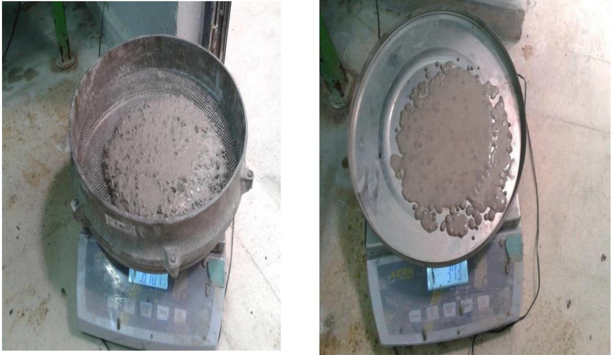
**Figure I.14 :** Dispositif de l'essai de stabilité au tamis
