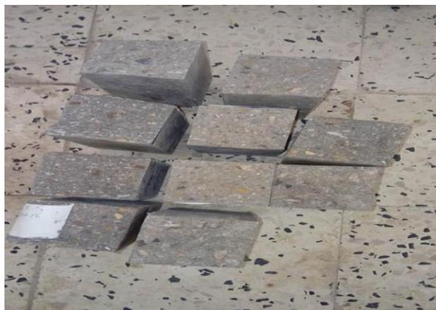
**Figure III. 12 :** Le mode de rupture obtenu en traction par flexion
