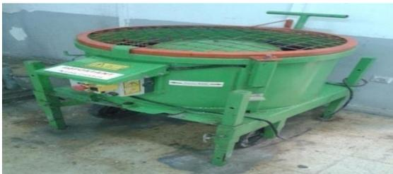
Figure II.1 : Malaxeur de béton auto plaçant
