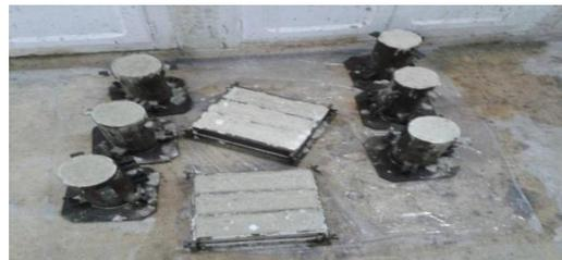
Figure II.2 : Moules de béton auto plaçant
