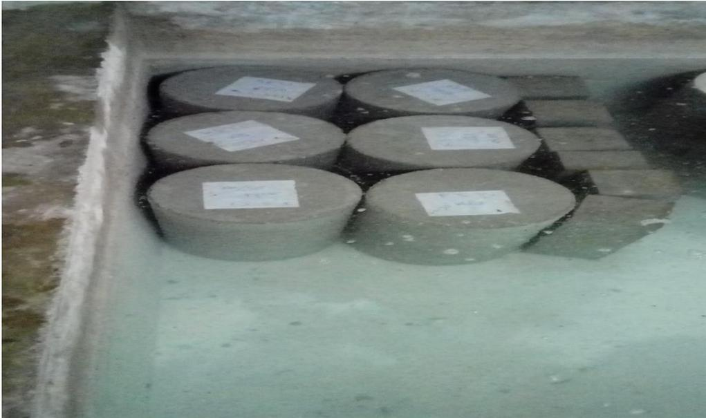
**Figure II.3 :** Conservation des éprouvettes
