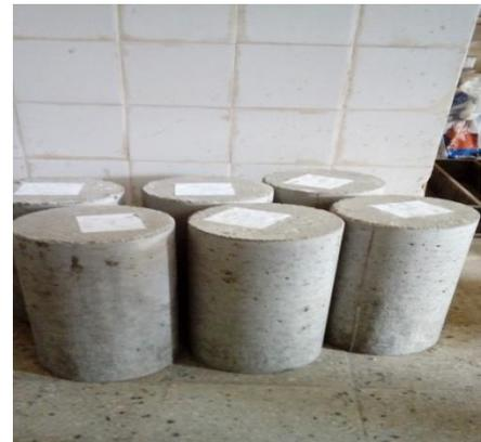
**Figure III.7 :** Eprouvettes d'essai de compression
