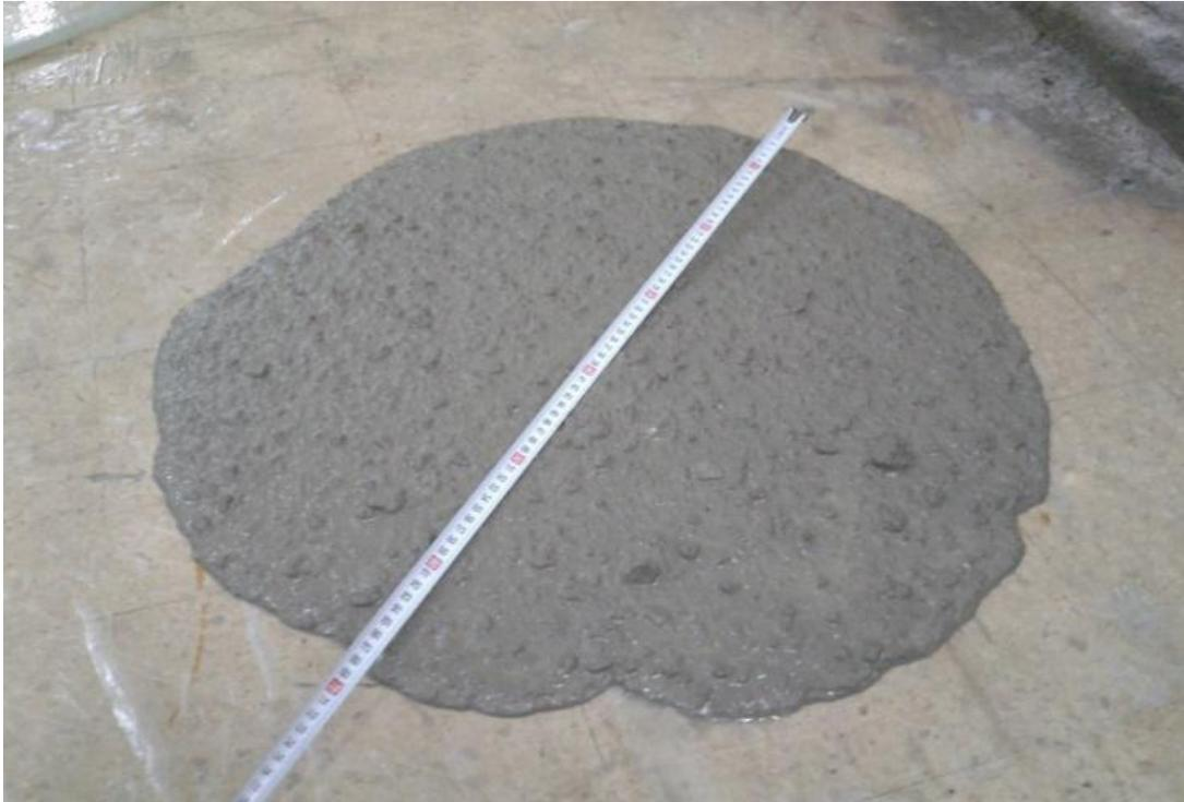
**Figure III.1** : l'essai au cône d'Abrams
