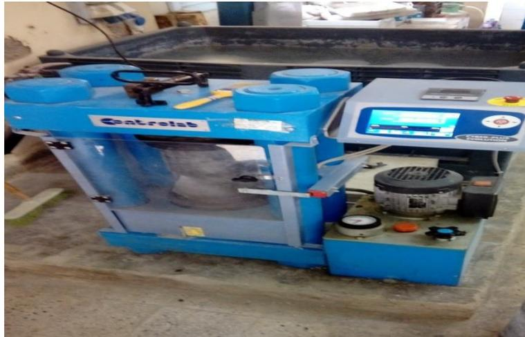
**Figure III.8 :** Presse utilisée pour mesurer la résistance à la compression
