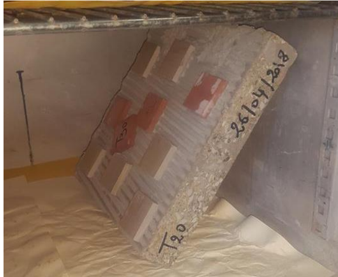
Figure III. 29 : Maquette d'essai dans l'étuve pour l'action de chaleur.
