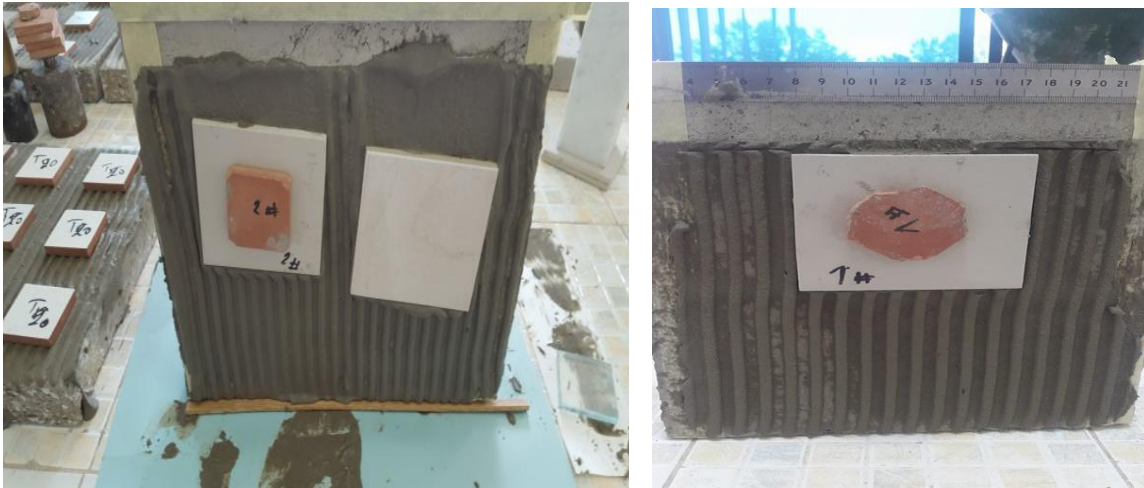
Figure III. 27 : Essais de glissement [photo prise au laboratoire de CETIM 25/04/2018].
