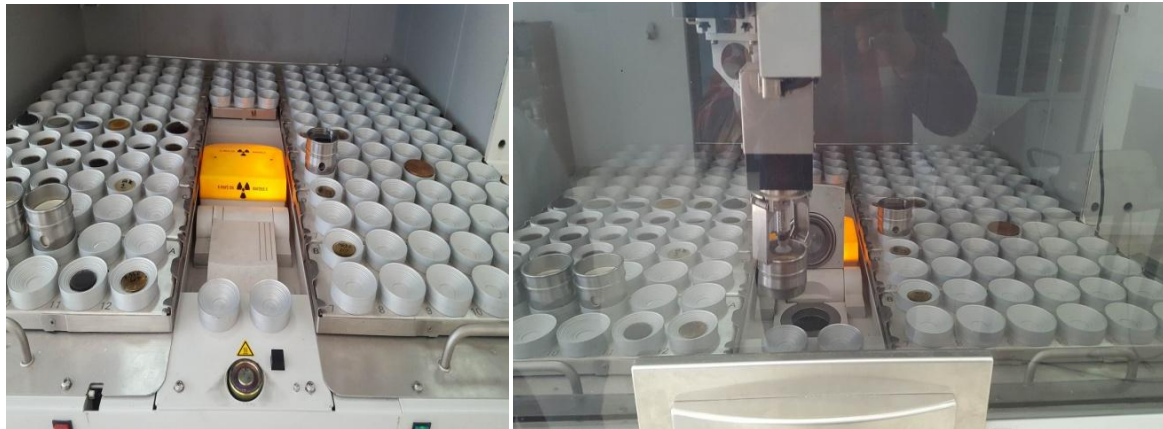
Figure III. 2 : Poste échantillon analysé automatiquement par la fluorescence X [photo prise au CETIM le 22/04/2018].
