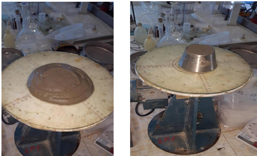
Figure III. 20 : Détermination de l'étalement du mortier frais [photo prise au laboratoire du CETIM 20/03/2018].
