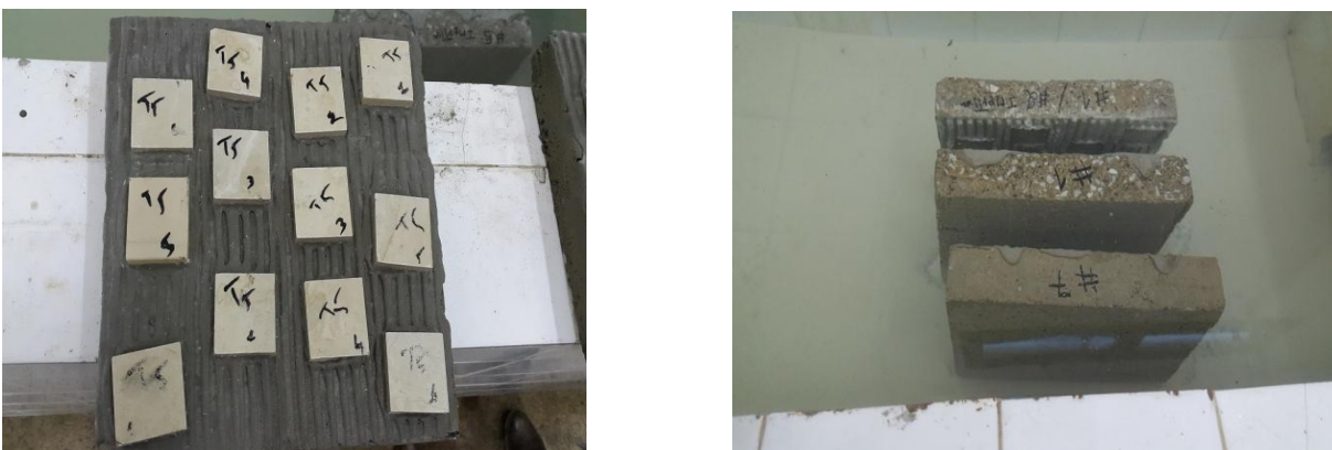
Figure III. 28 : Immersion des maquettes d'essai dans l'eau.
