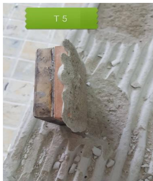
Figure III. 26 : Pièce de carreau de l'arrachement initial.
