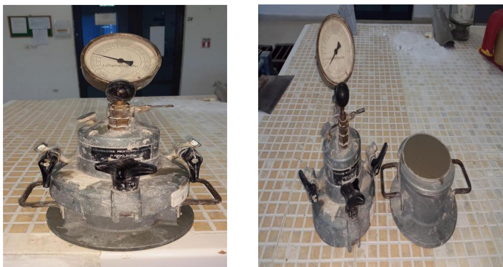
Figure III. 22 : Détermination de la teneur en air [photo prise au laboratoire du CETIM 20/03/2018].
