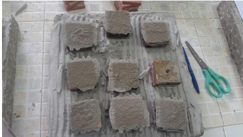
Figure III. 25 : Les maquettes d'essai après l'arrachement.
