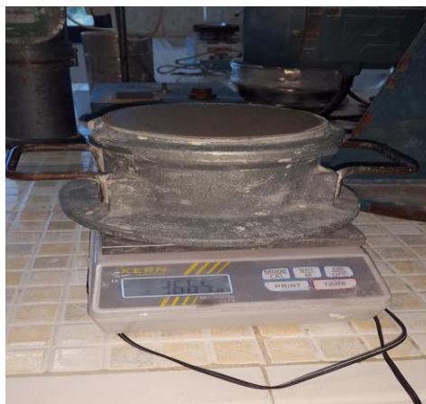
Figure III. 21 : Détermination de la masse volumique apparente [photo prise au CETIM 20/03/2018].
