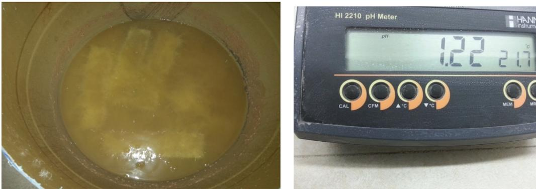
Figure 13: Bain de conservation HCl et mesure du pH
