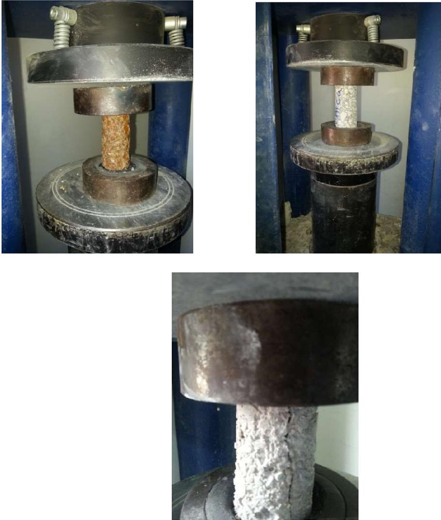
**Figure 9:** essai de compression des sur éprouvettes 4,5x9 cm
