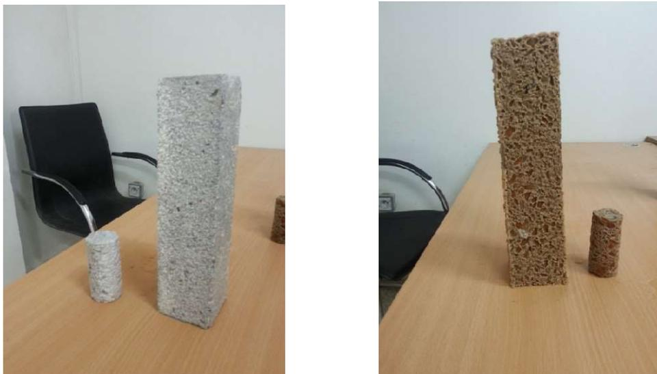
**Figure 15:** action des ions  $Cl^-$  et  $SO_4^{2-}$  sur bétons
