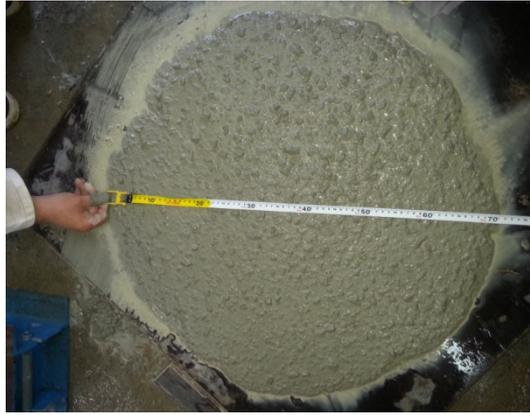
**Figure 6:** essai d'étalement
