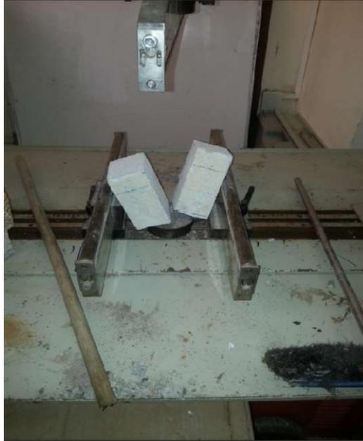
**Figure 10:** essai de traction par flexion
