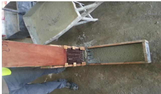
**Figure 7:** essai d'écoulement
