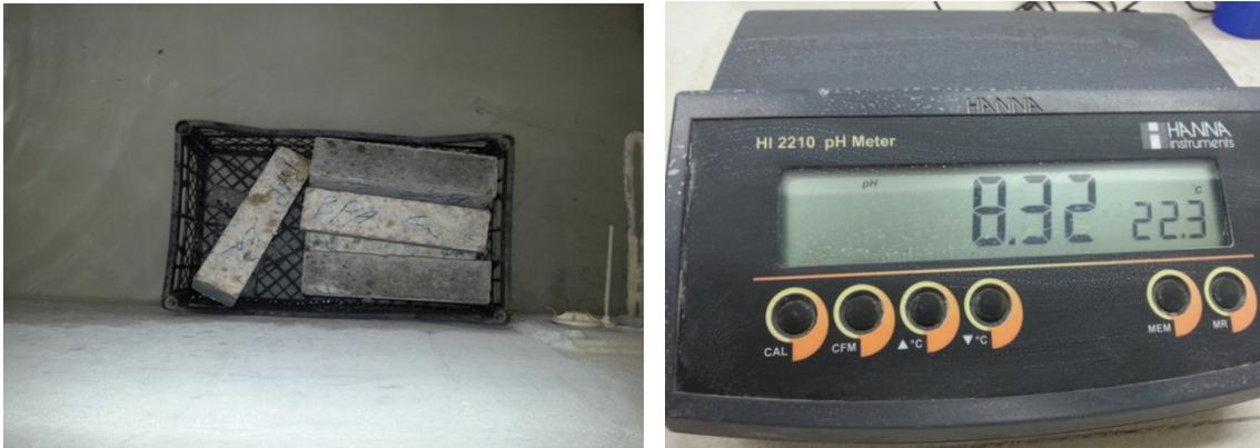
Figure 12: Bain de conservation  $H_2O$  et mesure du pH
