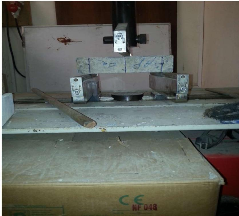
**Figure 2:** essai de traction par flexion
