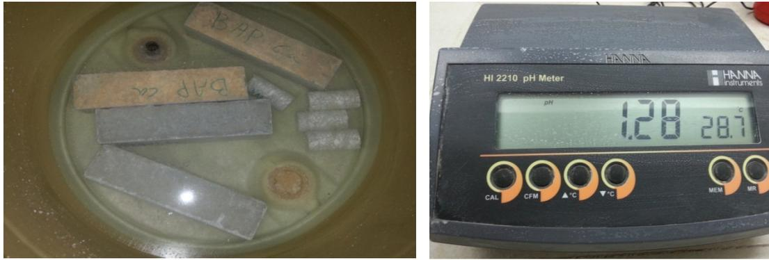
**Figure 14:** Bain de conservation  $H_2SO_4$  et mesure du pH
