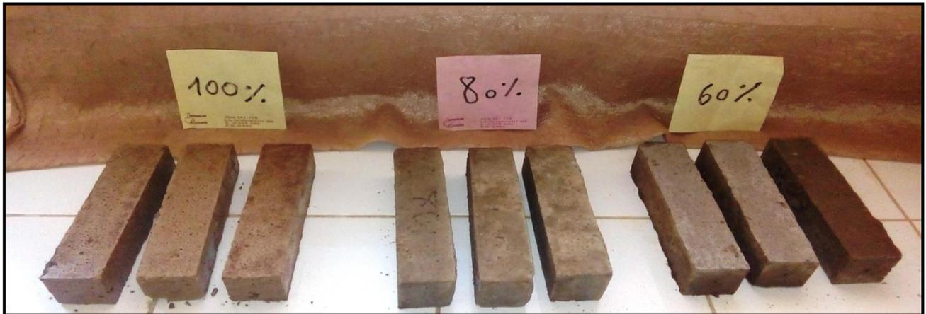
**Figure 22:** éprouvettes de mortier (Activation chimique).
