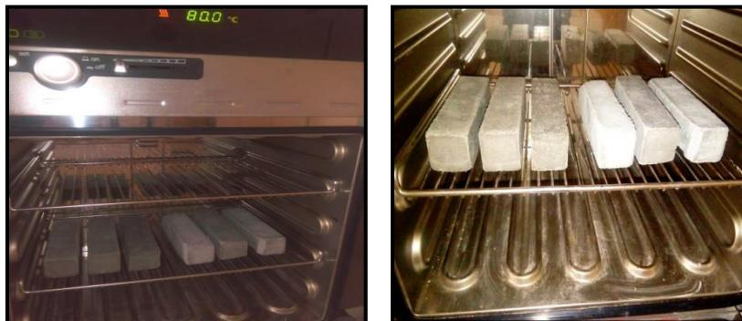
**Figure 20:** étuvage des éprouvettes
