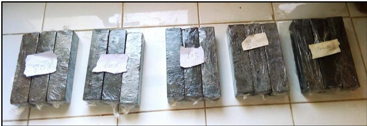
**Figure 19:** éprouvettes de mortier (Activation thermique)
