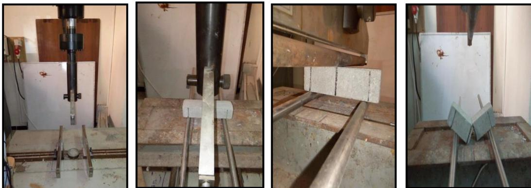
**Figure 34:** essai de flexion
