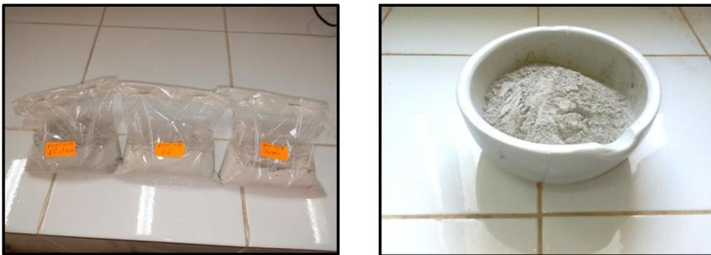
Figure 06 : laitier granulé broyer
