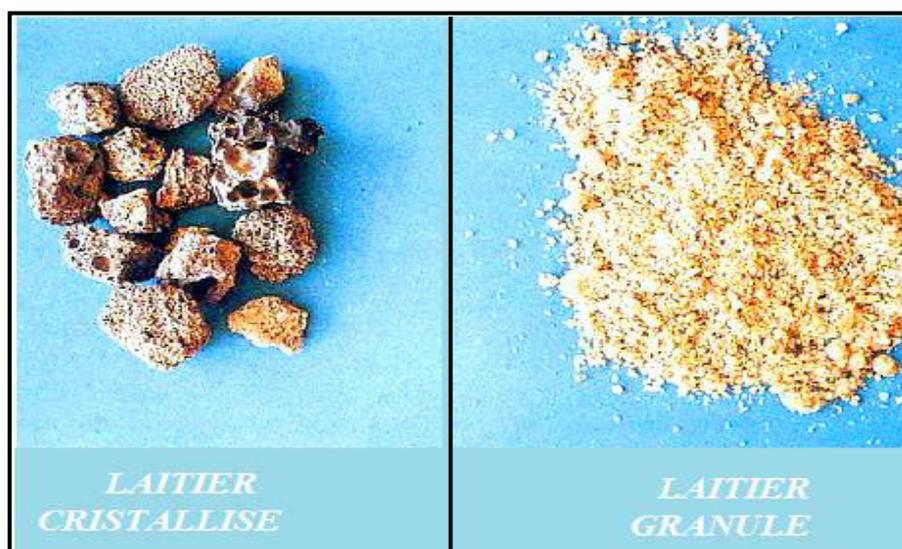
Figure 2 – Laitier cristallisé et laitier granulé [vitrifié] de haut fourneau
