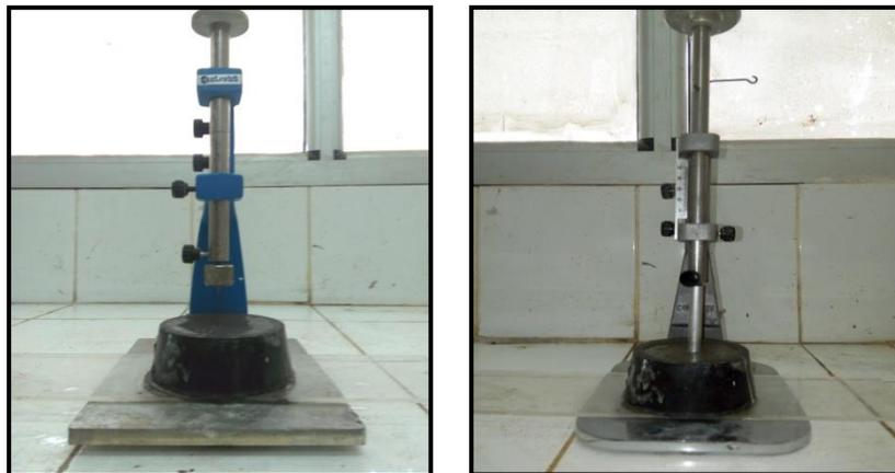
**Figure 23:** essai de délai de prise appareil de VICAT
