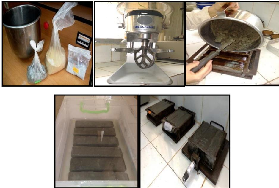
**Figure 17:** les différentes étapes de préparation d'un mortier.
