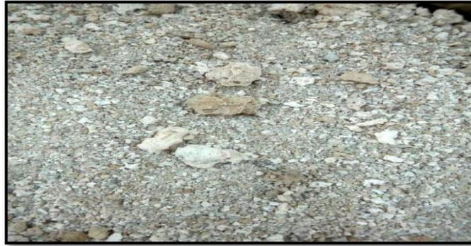
Figure 5 : Laitier granulé
