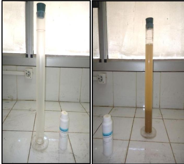
**Figure 15:** essai d'équivalent de sable.
