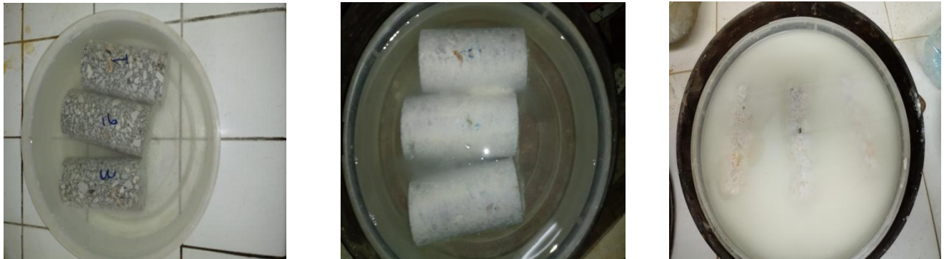
Figure III-10: Eprouvette de béton soumise à l'attaque acide sulfurique
