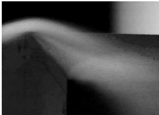
**Figure 1. 12: c)** Visualisation de la structure tourbillonnaire longitudinale sur l'arête latérale gauche de la lunette arrière (vue de  $\frac{3}{4}$  arrière) [1]
