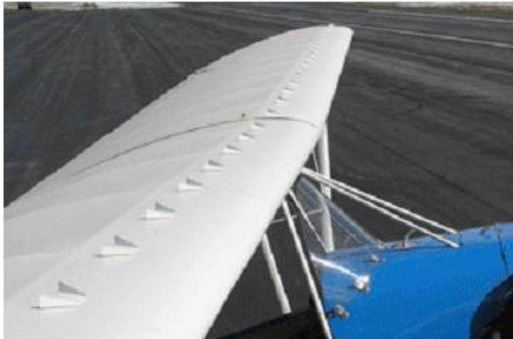
**Figure 2. 2:**Générateur de vortex passif type tabs, installés sur Stewart Headwind [15]
