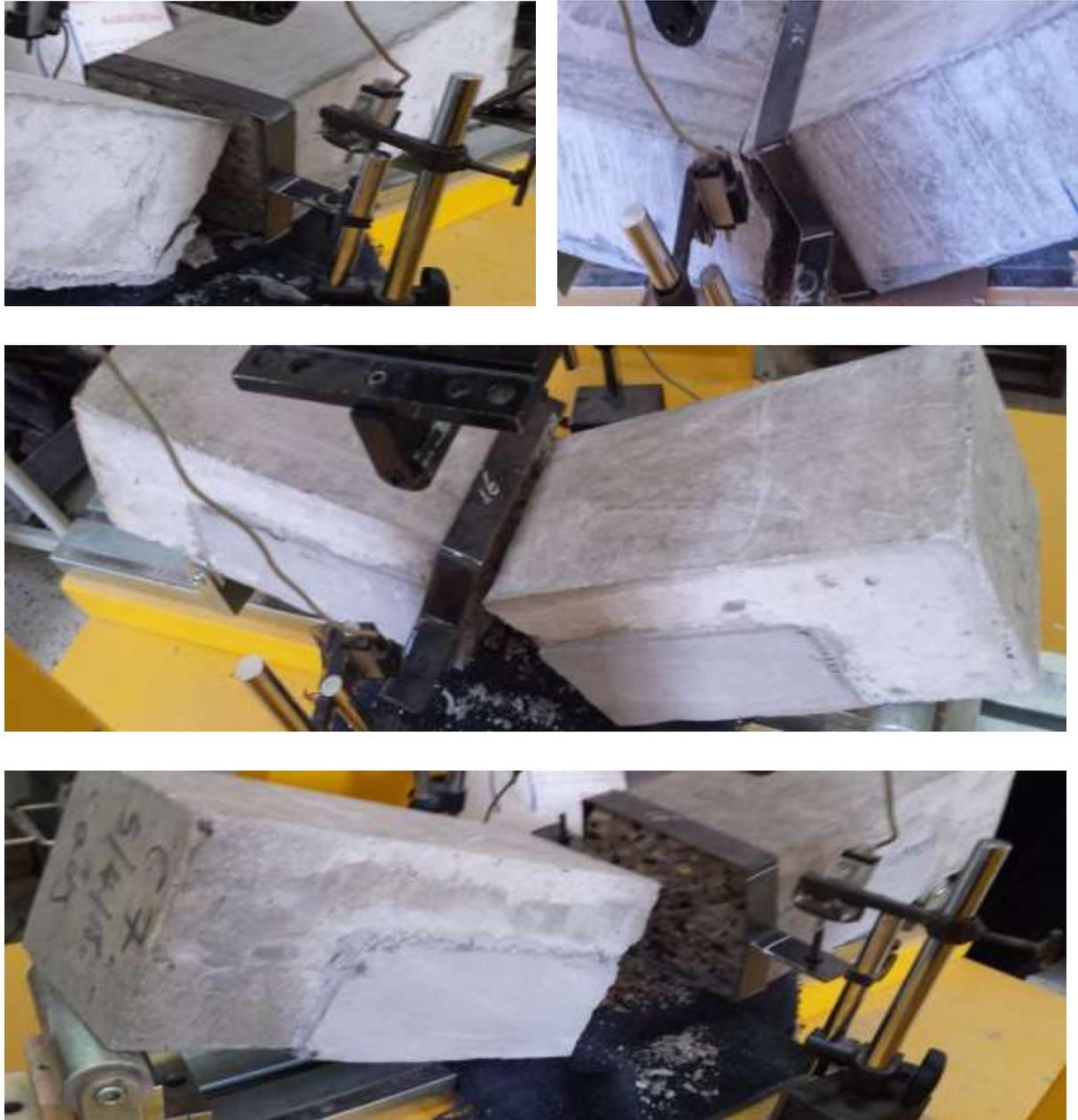
**FigureV.22** : mode de rupture des TRM
