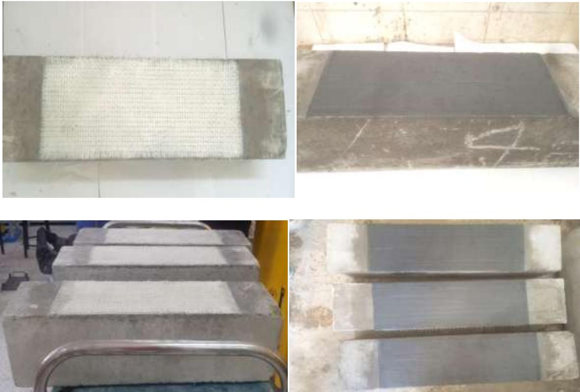
**Figure IV.20** : séchage des éprouvettes préparées à l'aire libre.
