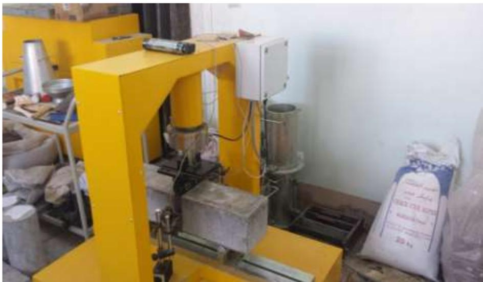
Figure V.2 : schéma de disposition de la poutre sur la machine
