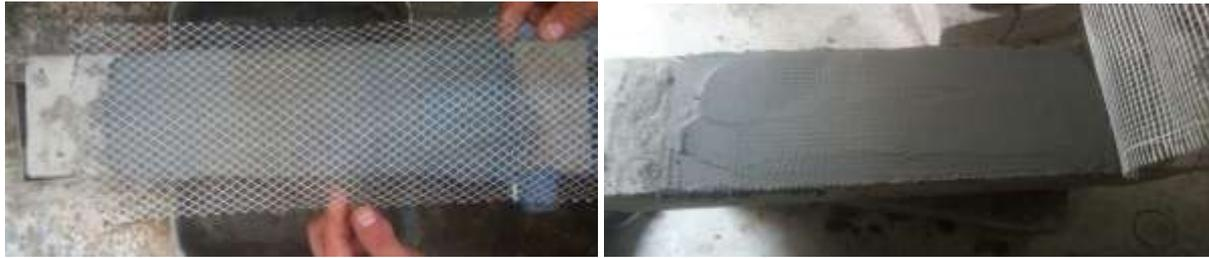
**Figure IV.10 :** Application de deuxième couche en mortier sur les grilles
