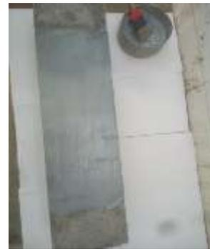
**Figure IV.17** : application de la couche de colle sur la surface de béton
