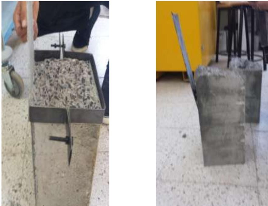
**Figure V.21 :** Mode de rupture des PRF
