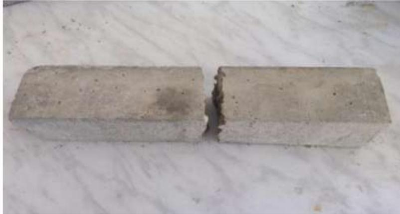
**Figure V.20 :** Mode de rupture de béton témoin (non renforcé)
