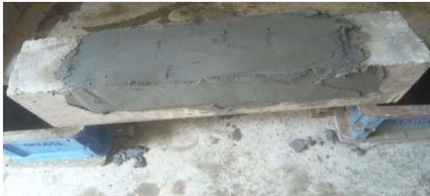
**Figure IV.11 :** application de la couche de mortier sur la surface tendue et les surfaces latérales.
