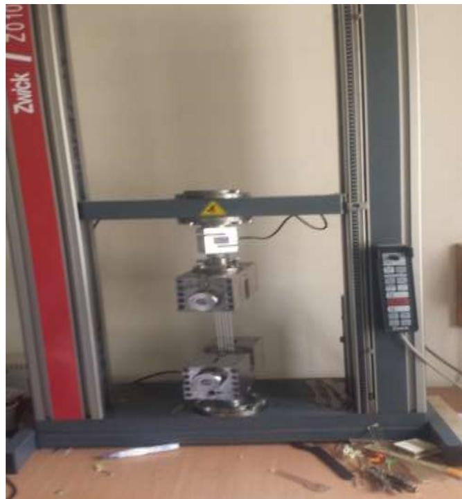
**Figure III.12** : machine de traction zwick-Rowel
