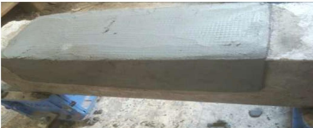
**Figure IV.14** : séchage des éprouvettes préparées à l'air libre pendant 28 jours
