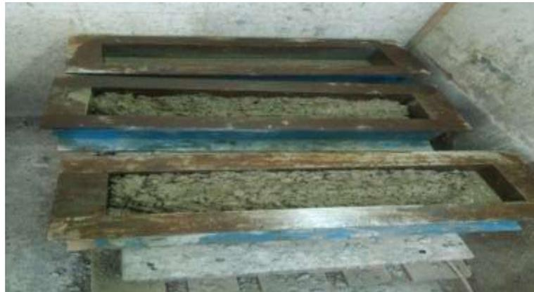
**Figure IV.3 :** mise en place des poutres sur la table vibrante
