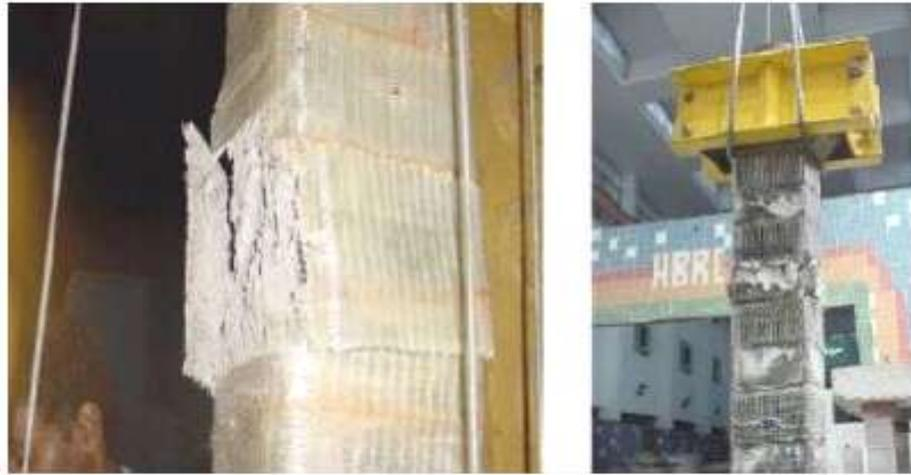
**Figure II.5 :** confinements d'un poteau au moyen de PRF [1]
