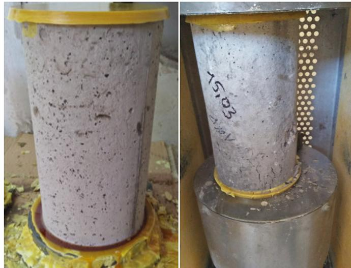
Photo IV.03. Essai de surfaçage et de la résistance à la compression.
