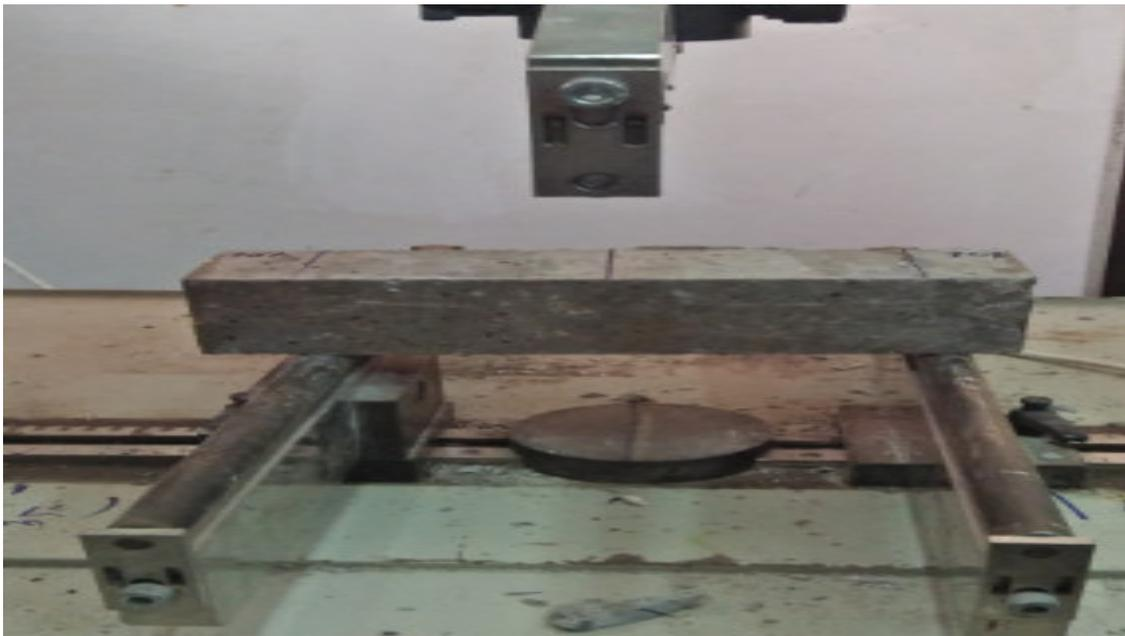
**Figure :** Essai mécanique de rupture par flexion
