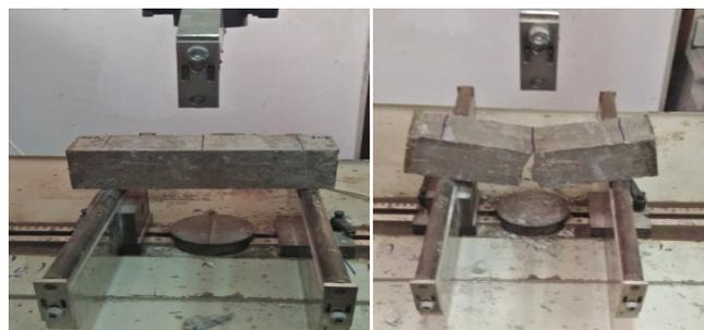
**Photo IV.0 4.**Essai de la résistance à la traction par flexion.
