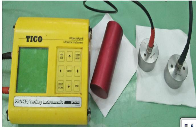
**Photo IV. 05.** Appareil à ultrason.
