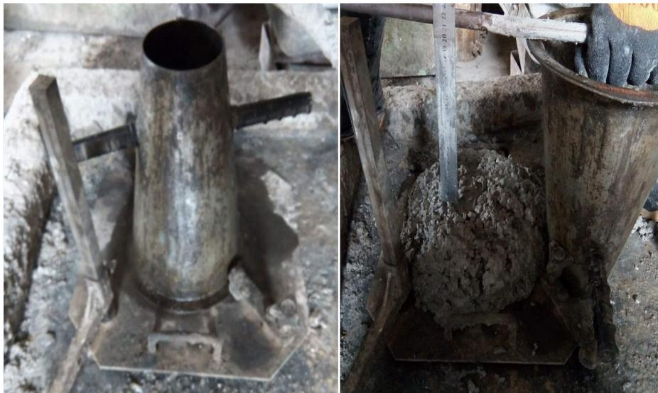
Photo IV.1. Essais d'affaissement au cône d'Abrams.
