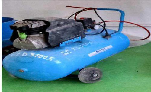
**Figure II.13:** Appareil à air comprimé pour démoulage.
