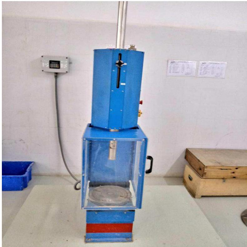
**Figure II.5:** Machine Proctor normal et modifié
