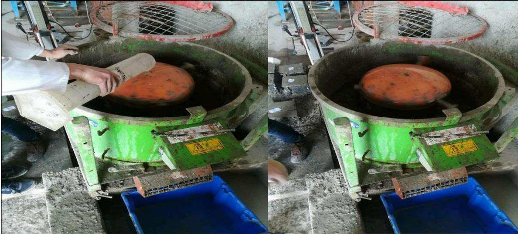
**Figure II.10:** Malaxage du béton.
