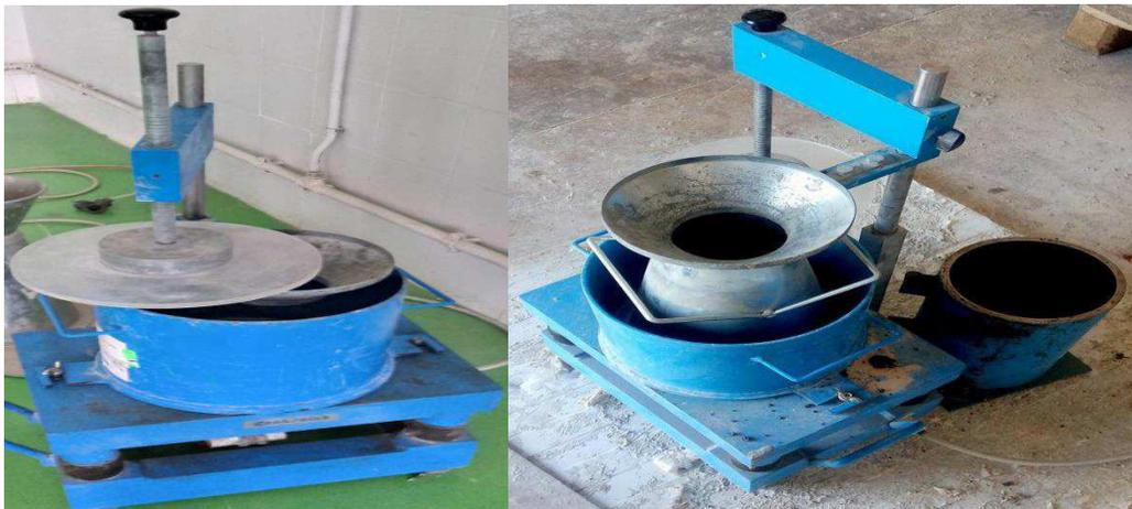
**Figure II.4:** Appareil d'Essai Vébé
