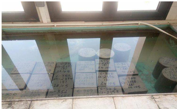
**Figure II.14:** Conservation des éprouvettes.
