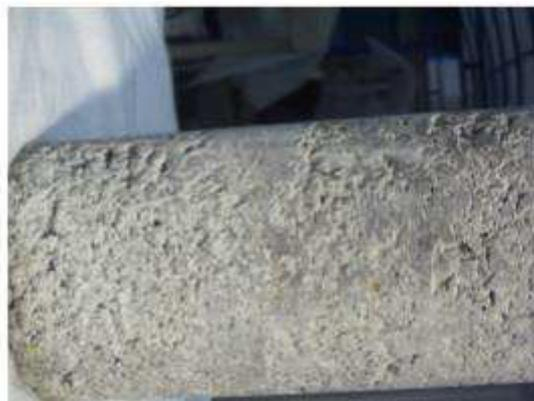
**Figure I.12 :** Ségrégation des éprouvettes de BCR.
