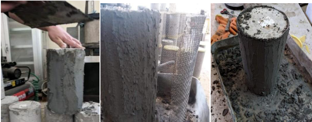
Figure III.21 : Renforcement des éprouvettes en béton par la technique TRM (Grille en Verre).
