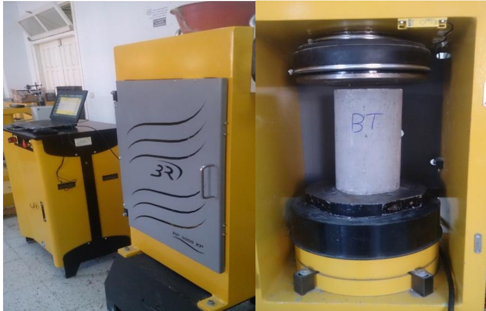
Figure III.28 : Eprouvette soumise à la compression simple
