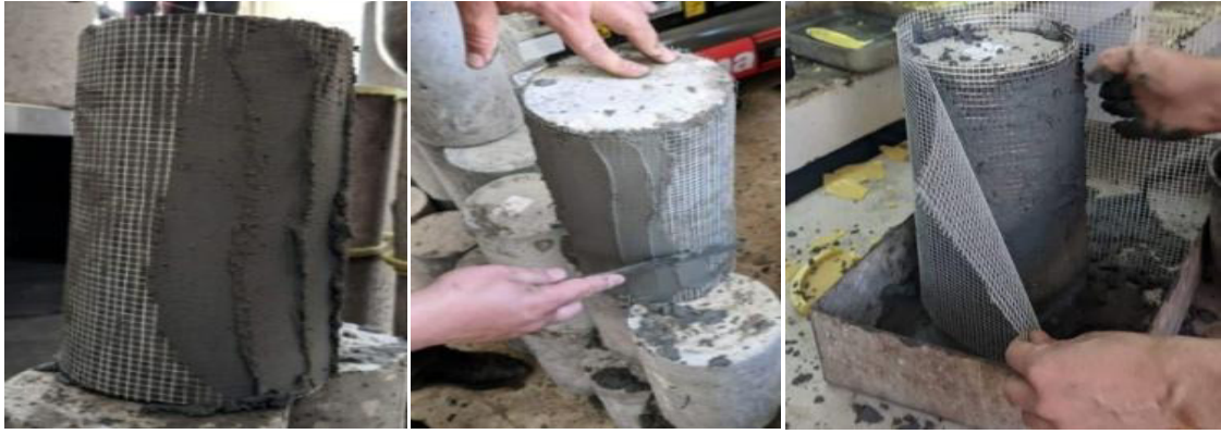
Figure III.21 : Renforcement des éprouvettes en béton par la technique TRM (Grille en Verre).
