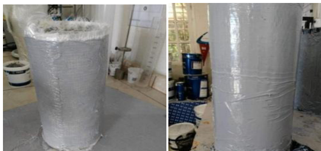
Figure III.27 : Epreuves confinés par (PRFV) et (PRFC) .
