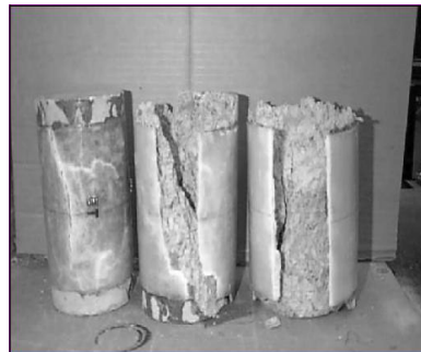
Figure II.18 Modes de rupture d'un béton renforcé par un PRF à base de fibre de verre et de résine epoxy soumis à une charge de compression [14].
