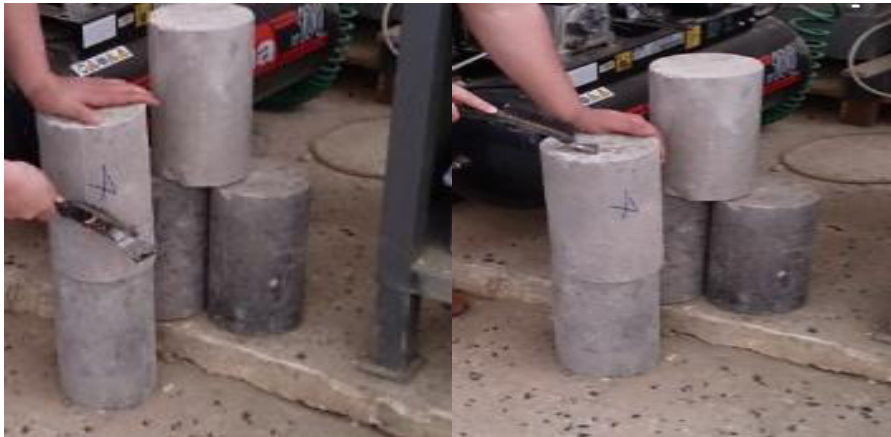
Figure III.18 : Etapas de traitement de la surface des éprouvettes.
