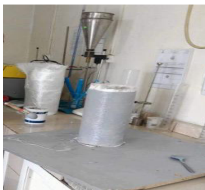
Figure III.26: Collage de tissus avec la Résine.
