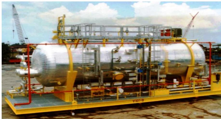
Figure III.9 : Vue extérieure d'un dessaleur électrostatique [3]
