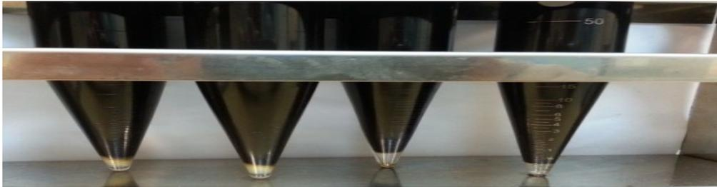
**Figure V.12** : Analyse de BSW des échantillons du brut
